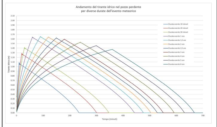
Dal grafico si evince che il tempo di vuotamento del pozzo risulta in ogni simulazione effettuata inferiore alle 48 ore.
