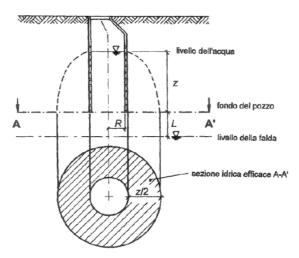
L'effettiva area drenante del pozzo (A) è assunta come un anello di larghezza z/2 attorno alla base del pozzo; non si considera la base drenante del pozzo per tenere conto della sua possibile occlusione.
