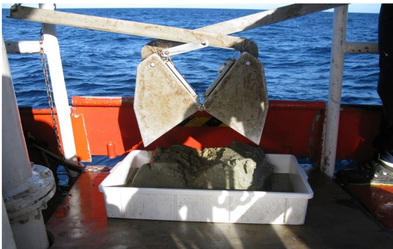
Fig. 3.D – Benna Van Veen con capacità da 20 litri utilizzata per il prelievo dei sedimenti e del macrozoobenthos nel corso dei campionamenti effettuati nell'area di studio.
