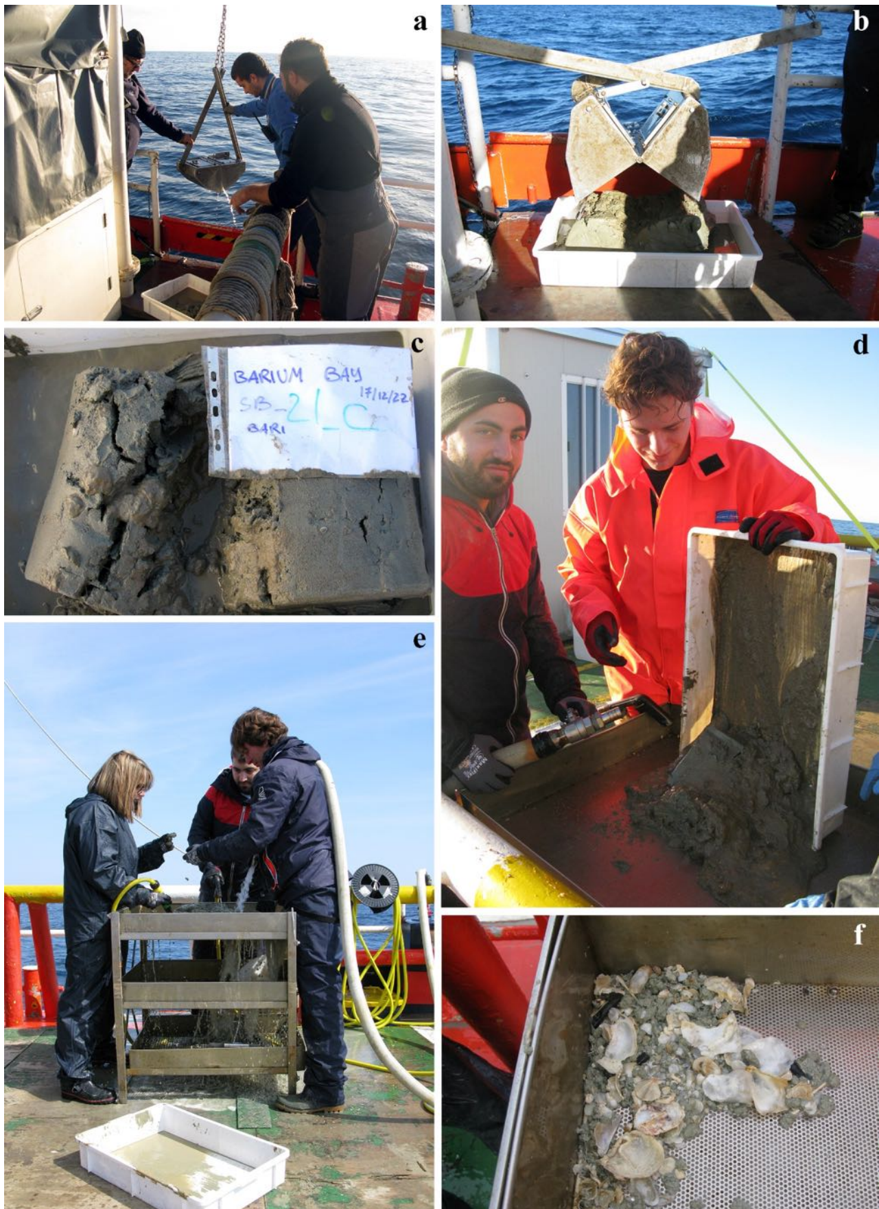
Fig. 5.1.1.A – Fasi del campionamento del sedimento e del macrobenthos. a) Salpaggio della benna van Veen a bordo dopo aver prelevato il sedimento; b) svuotamento del contenuto della benna in vasconi di plastica; c) etichettatura del campione; d) svuotamento del sedimento su tavolo a setacci multipli utilizzato per la cernita ed il prelievo degli organismi bentonici; e) fase di setacciatura del sedimento; f) materiale biologico setacciato da un campione.
