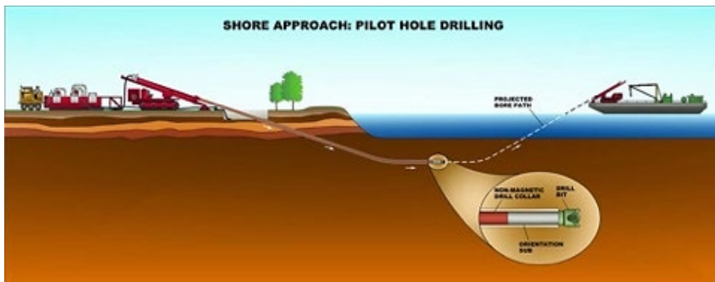
Posa del cavo nel punto di sbarco con tecnica TOC
