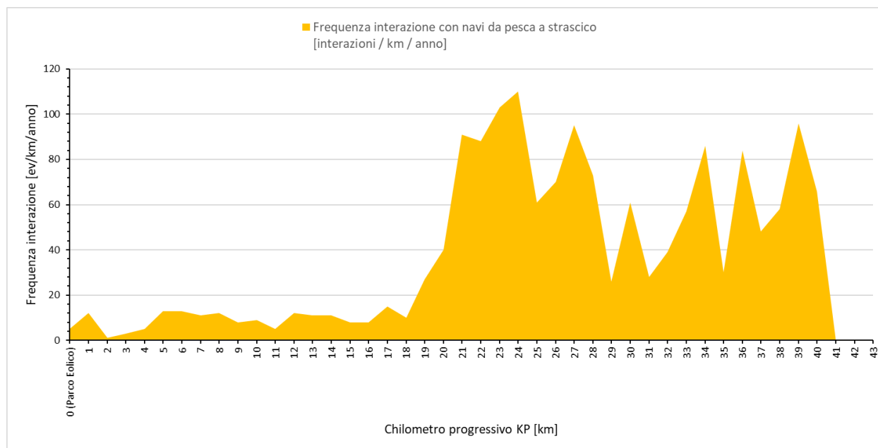
Frequenza interazione con cavidotti per imbarcazioni adibite alla pesca a strascico, caratterizzato per KP di cavidotto
