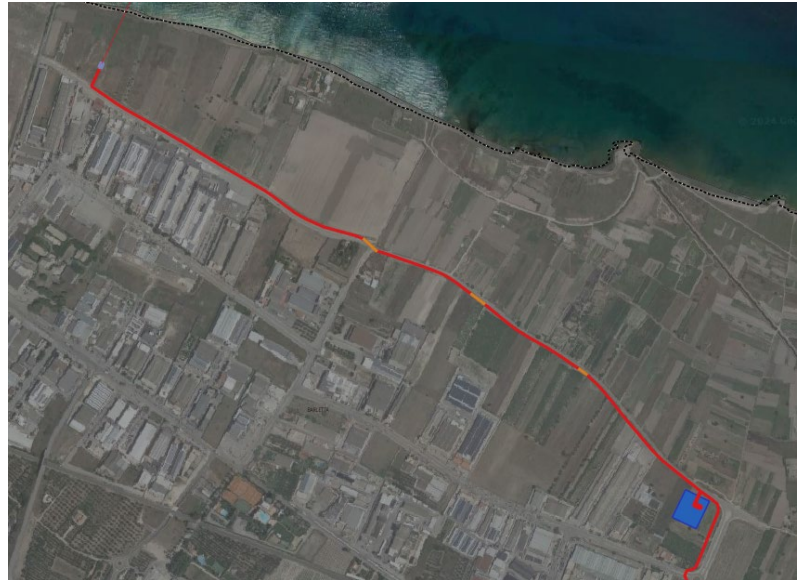
Il cavidotto interrato in progetto inquadramento generale
