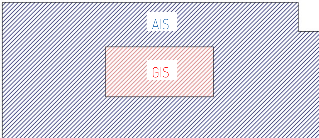
Schema dimensionale della differenza di consumo di suolo tra isolamento in GIS e Aria
