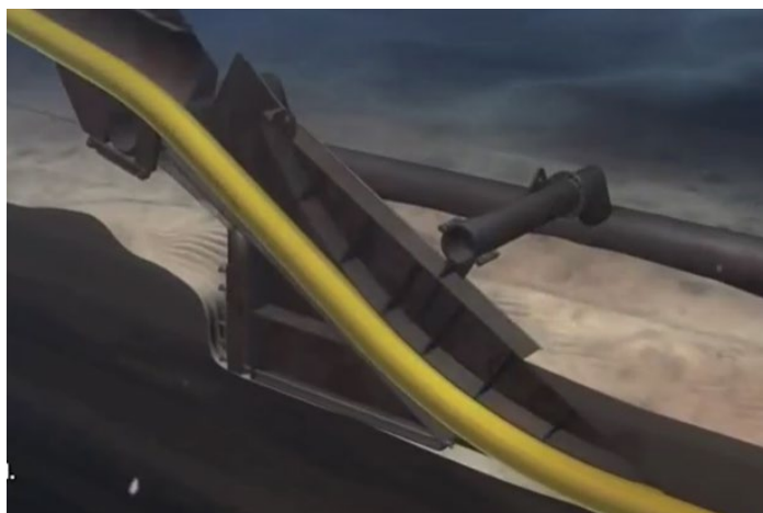
Aratro marino e schema tridimensionale della trincea di scavo (tecnica adottata)
