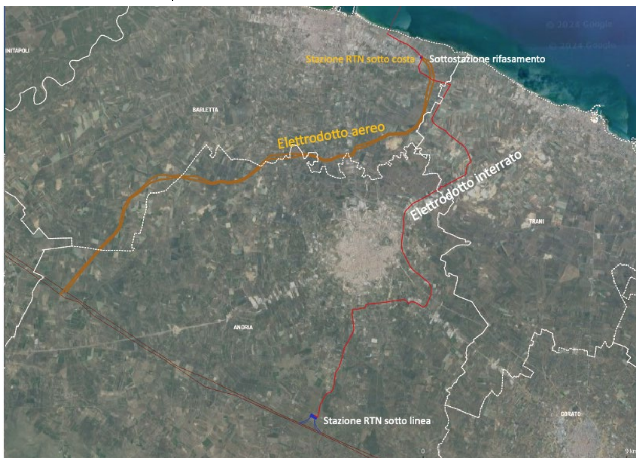
Le alternative di connessione alla rete: alternativa A – in rosso (selezionata) e alternativa B - in arancione (scartata)
