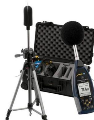
Il microfono utilizzato deve essere del tipo da esterni a campo libero. Qualora la sorgente non sia localizzabile o si sia in presenza di più sorgenti deve essere adottato un microfono da esterni ad incidenza casuale. Il microfono deve essere dotato di schermo antivento.
