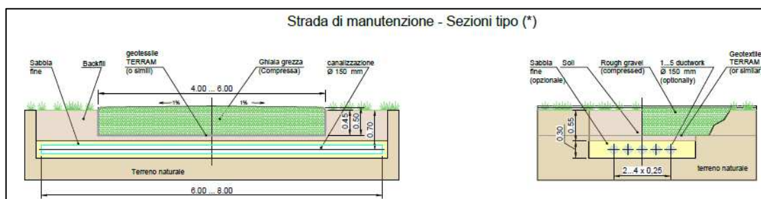
Figura 21 Sezioni stradali di campo
