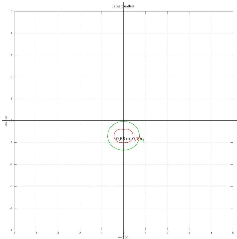
Figura 12: Curve di equivello per il campo di induzione magnetica generato dalla linea AT (tipologia 2 – due terne AT 36 kV)
