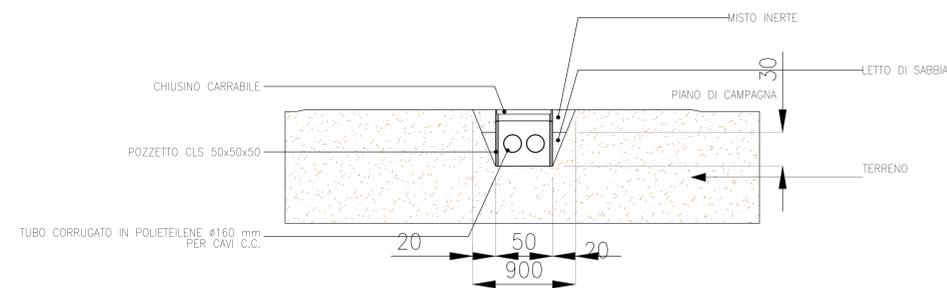
POZZETTO TIPO CAVIDOTTI C.C. *scala 1:10*
