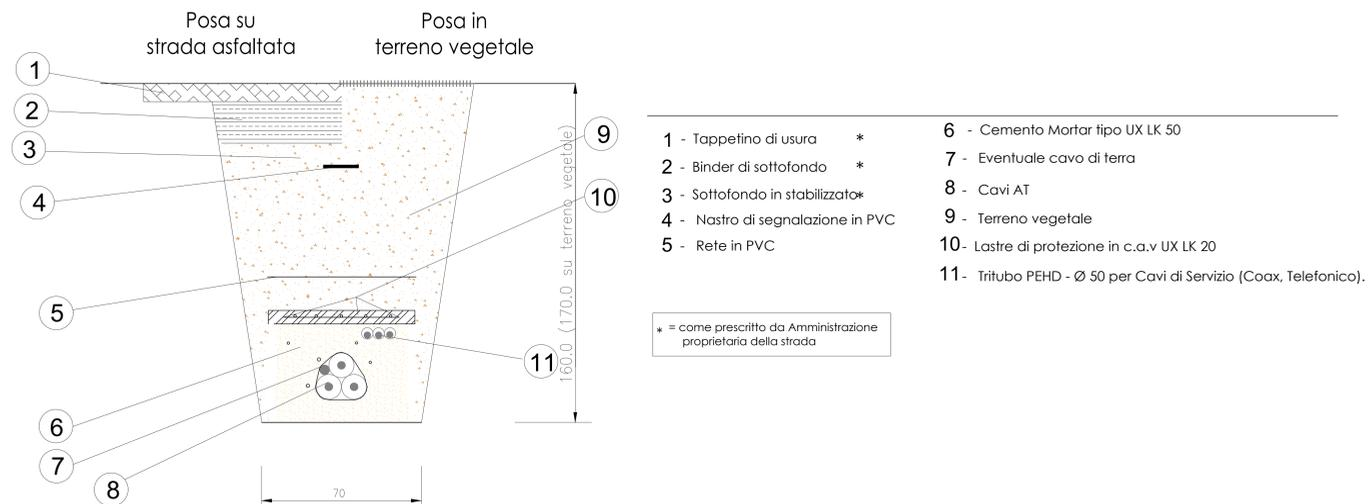
SEZIONI TIPO CAVIDOTTI C.C. *scala 1:20*
