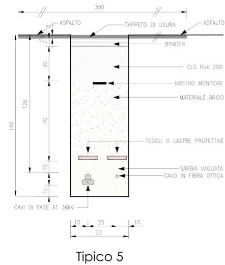
SEZIONE CAVIDOTTO DI COLLEGAMENTO 36kV
