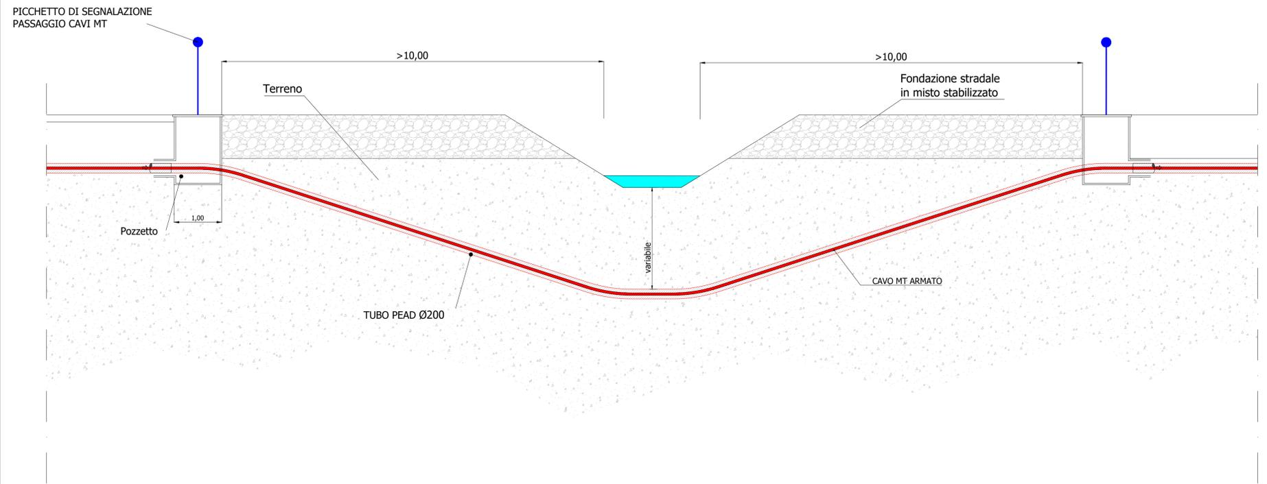
POSSIBILE SOLUZIONE MEDIANTE T.O.C. SEZIONE B-B
