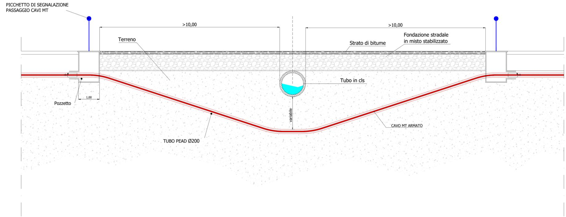
POSSIBILE SOLUZIONE MEDIANTE T.O.C. SEZIONE B-B
