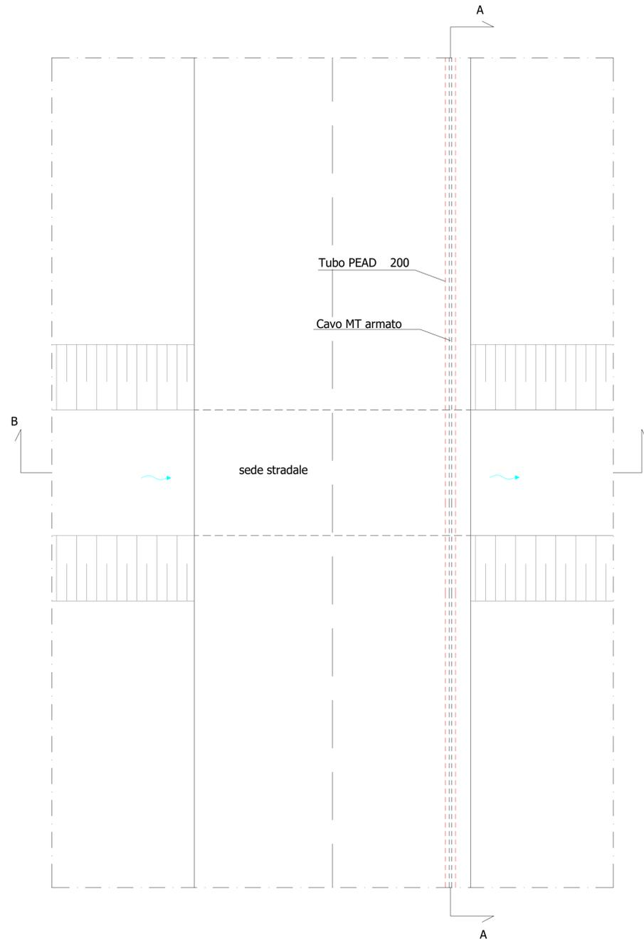
CASO C: Attraversamento di manufatto composto da soletta e spalle in cemento armato
