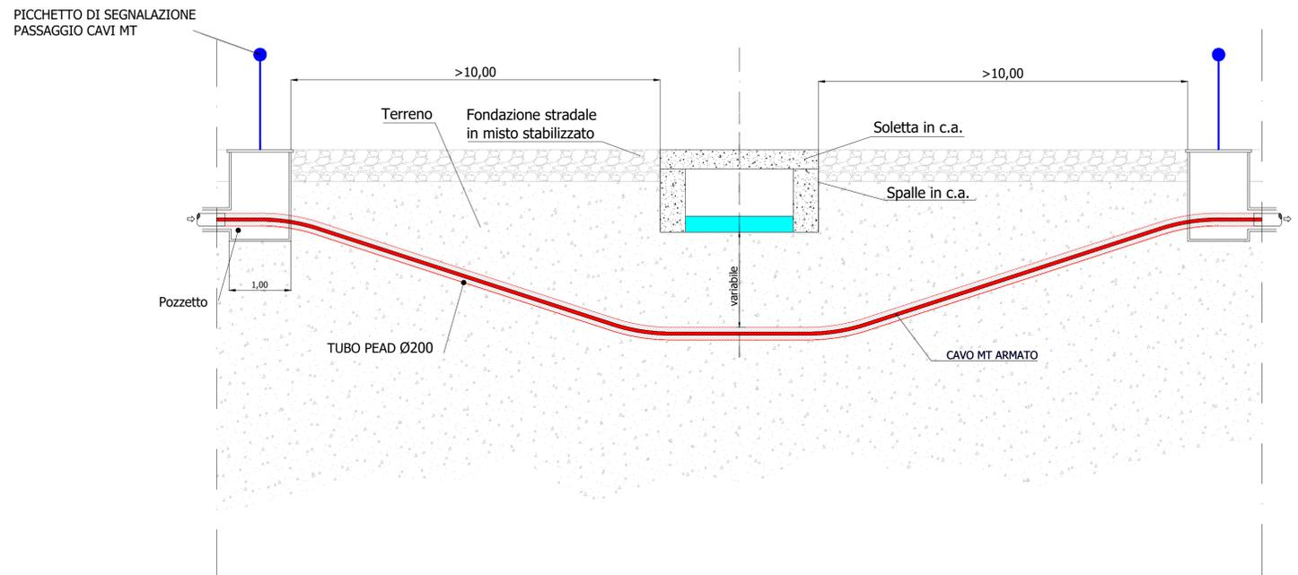
POSSIBILE SOLUZIONE MEDIANTE T.O.C. SEZIONE B-B
