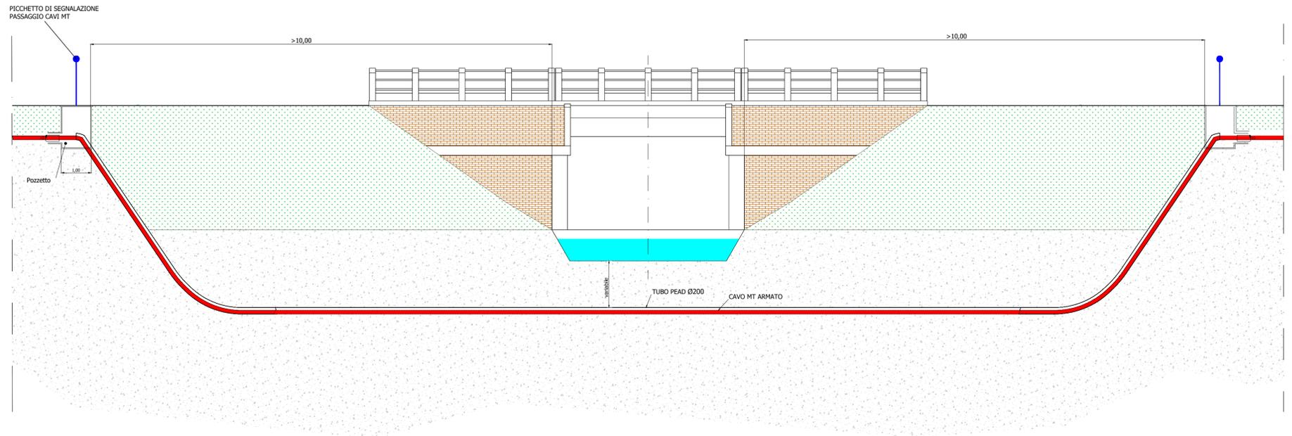
POSSIBILE SOLUZIONE MEDIANTE T.O.C. SEZIONE B-B
