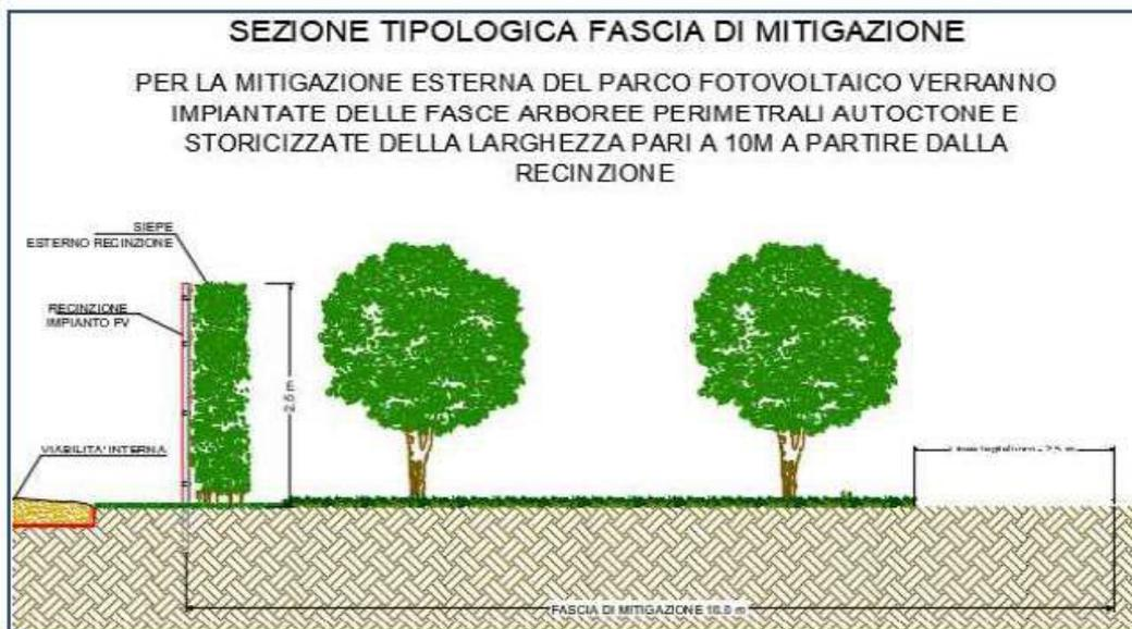
Figura 20 Tipico Fascia di mitigazione - Sezione
