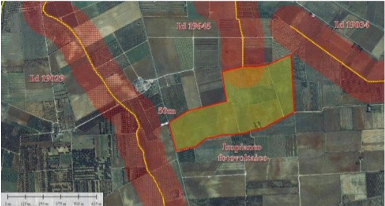
Figura 8. Distanze dell'impianto fotovoltaico dai buffer dei corsi d'acqua episodici nelle vicinanze (il buffer è ampio 150 m dall'asse del corso d'acqua e rappresenta l'unione delle aree di pertinenza fluviale e di modellamento attivo).
