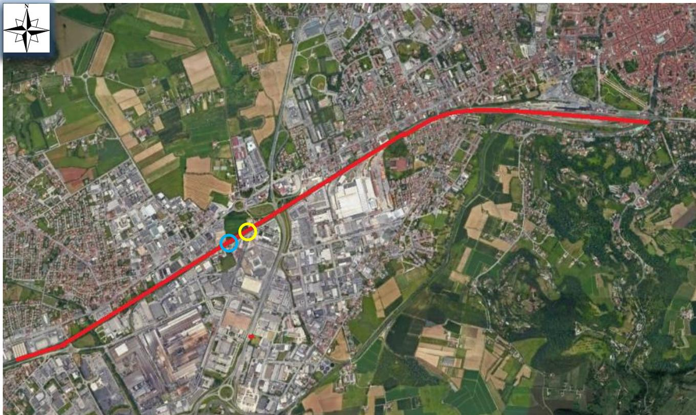
*Figura 1: Foto aerea dell'area d'interesse. In rosso il tracciato ferroviario della linea AV/AC di progetto, in celeste è indicata la precedente posizione del sottopasso SL04, in giallo è indicata la nuova posizione.*
