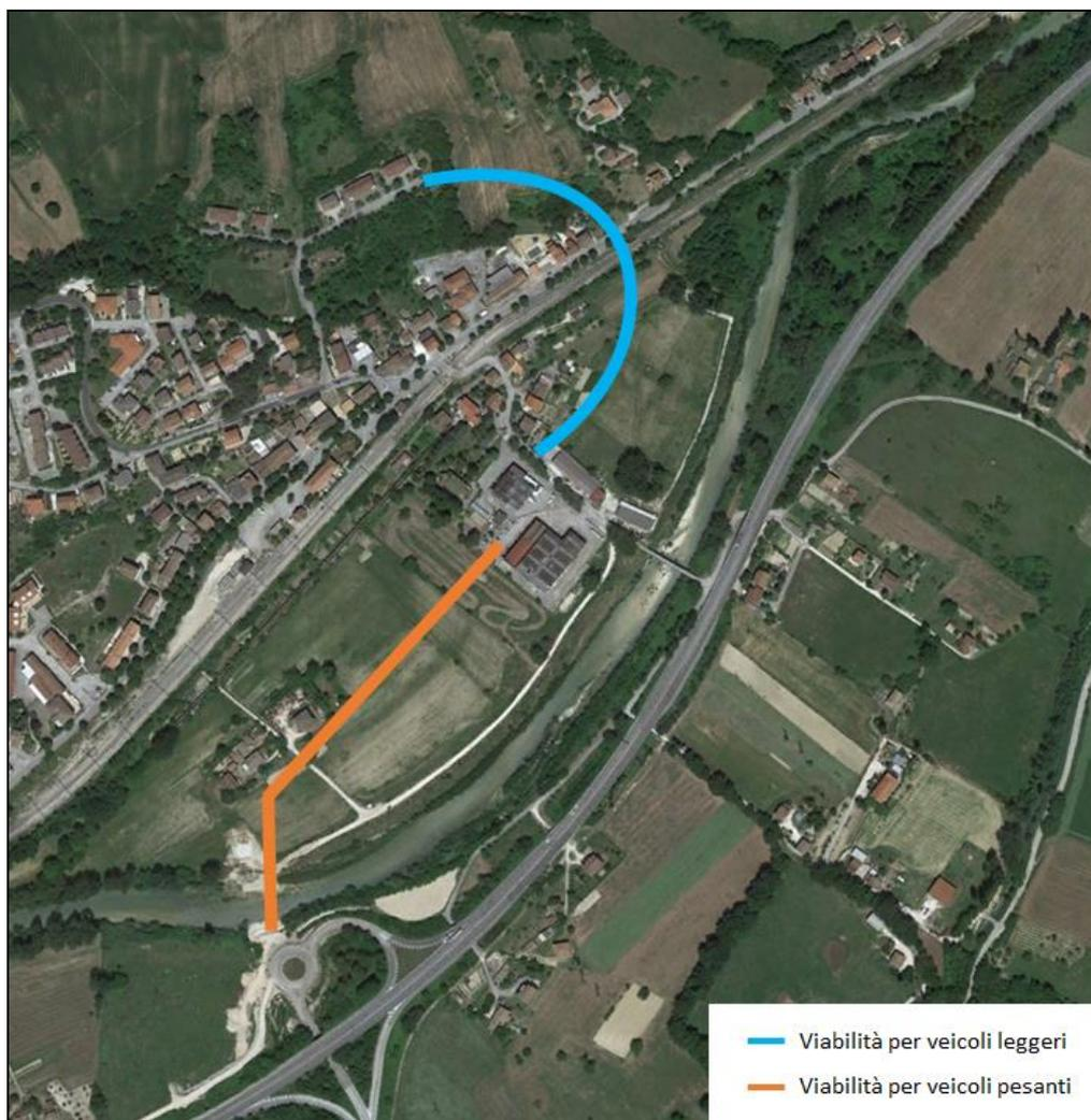
Figura 6 – Nuovi collegamenti proposti per l'intervento di soppressione del PL di Via F.lli Bandiera, Serra S. Quirico (Ancona)
