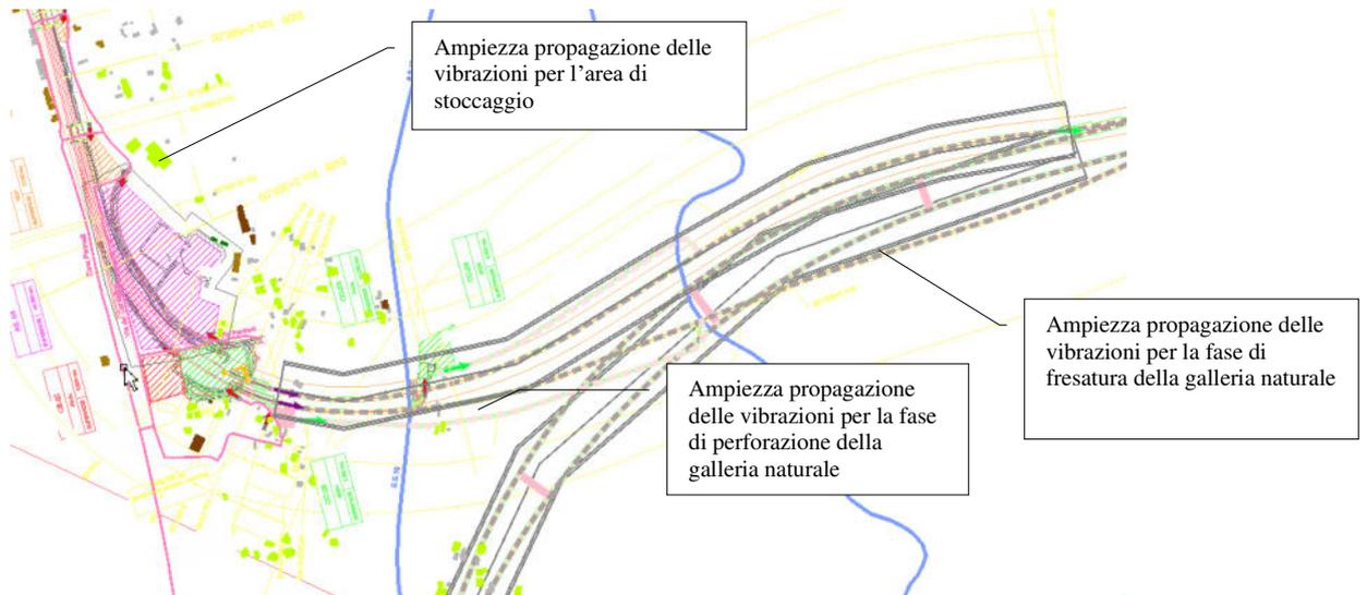
Figura 6-44- stralcio con ampiezza dell'aree di superamento interno agli edifici del limite delle vibrazioni per le aree GN02-GN03-AS.04
