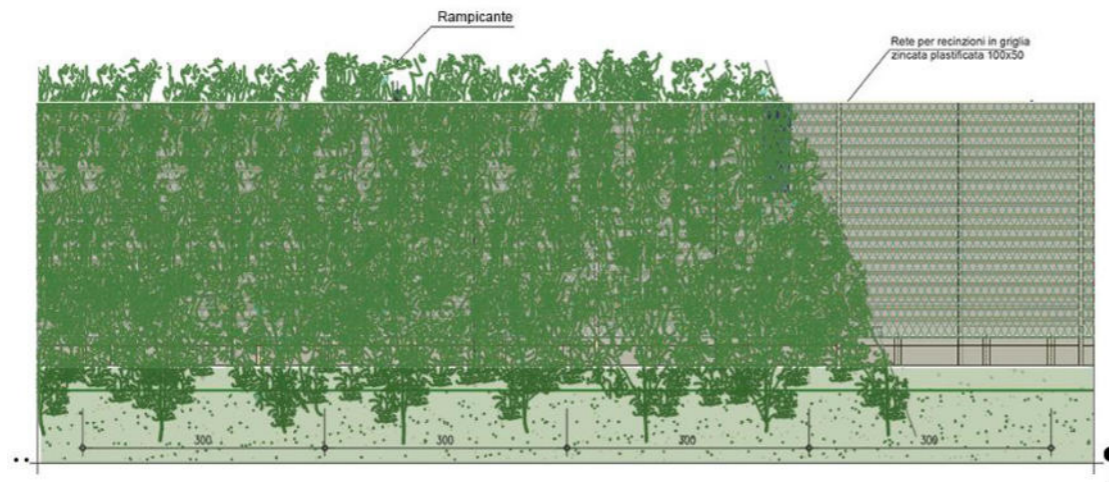
Figura 38 – Muro con barriera antirumore rivestito con rampicanti
