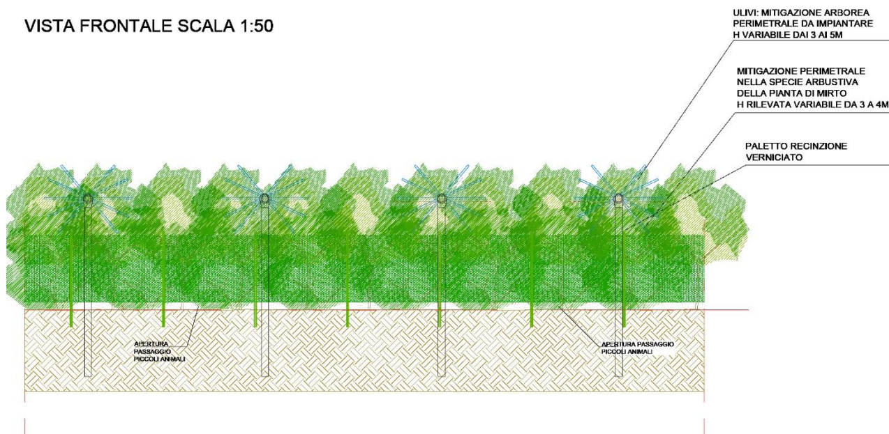
Figura 44: Dettaglio recinzione - prospetto esterno
