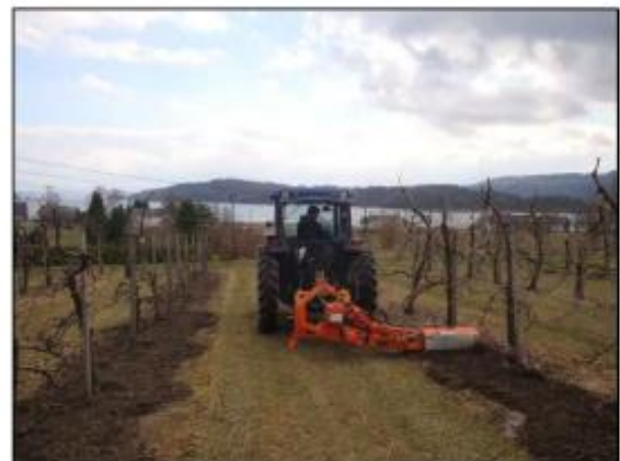
Figura 16: Esempio di fresatrice interceppo per le lavorazioni sulla fila
