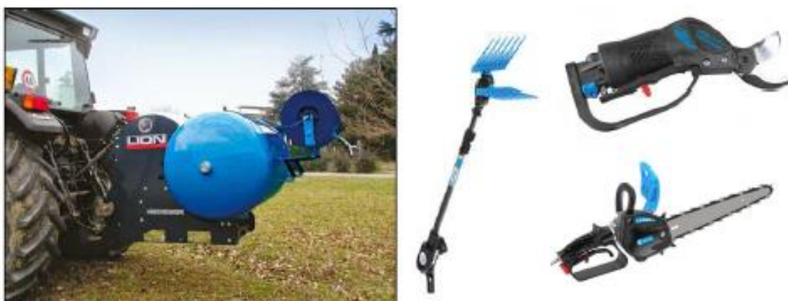
Figura 29: Compressore PTO per il funzionamento di strumenti pneumatici per l'arboricoltura
