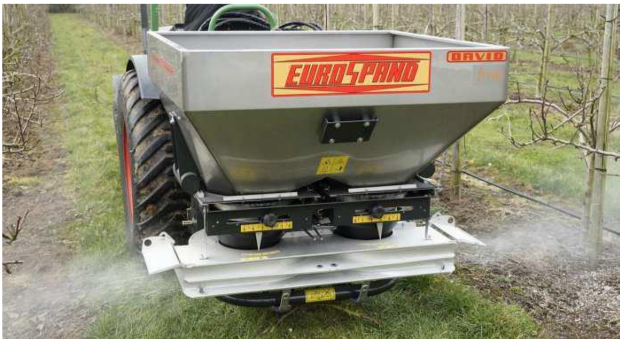
Figura 30: Esempio di spandiconcime localizzato mono/bilaterale per frutteti
