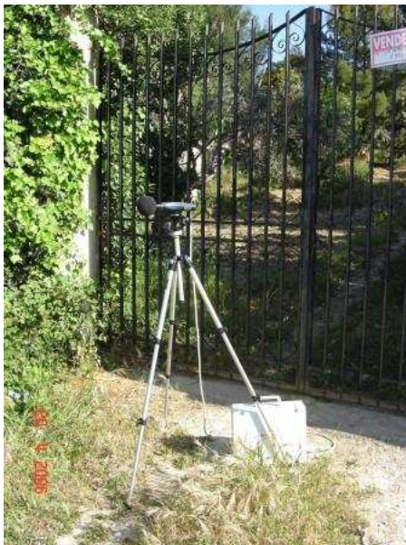
Posizionamento del fonometro presso il ricettore 245 e visuale sulla SS640
