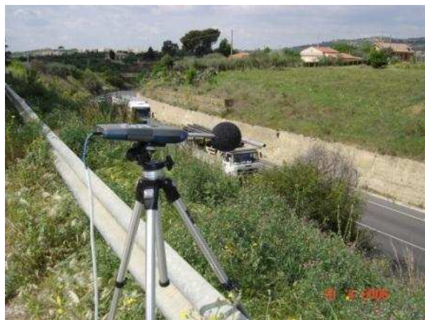
Posizionamento del fonometro presso il ricettore 220 e visuale sulla SS640
