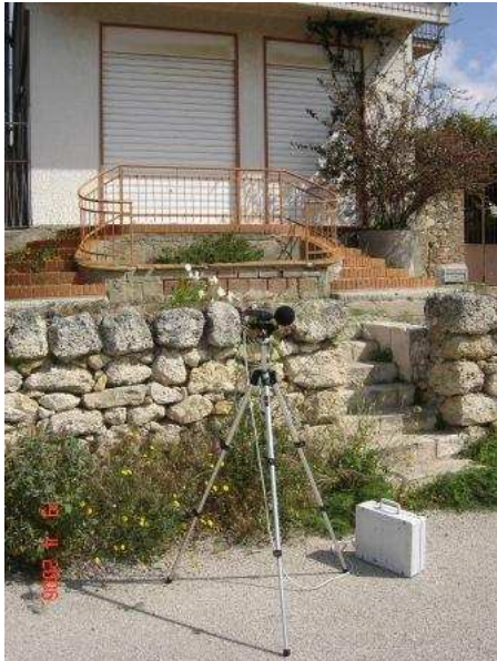
Posizionamento del fonometro presso il ricettore 75 e visuale sulla SS640
