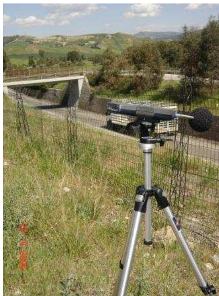
Posizionamento del fonometro presso il ricettore 363 e visuale sulla SS640
