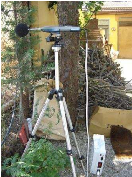
Posizionamento del fonometro presso il ricettore 300 e visuale sulla SS640
