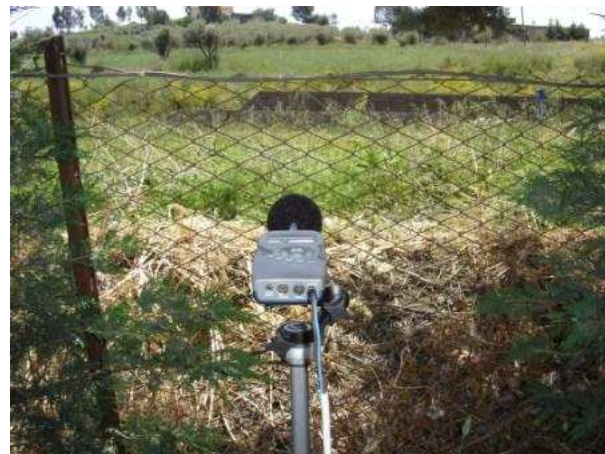
Posizionamento del fonometro presso il ricettore 300 e visuale sulla SS640
