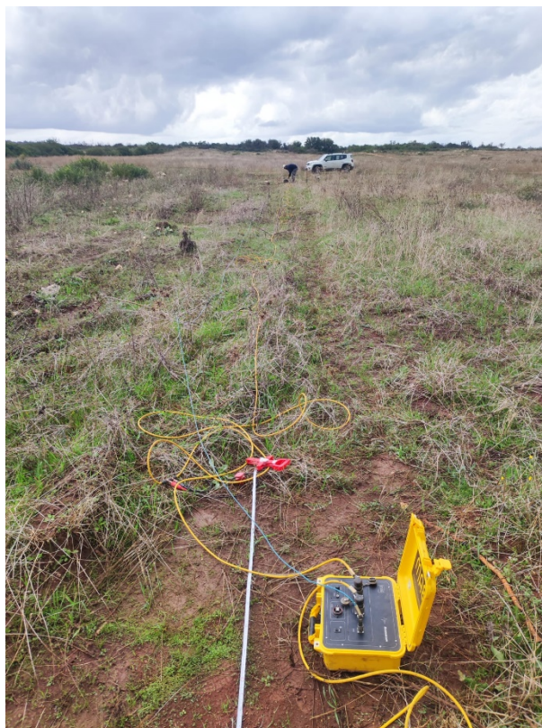
FOTO 1A: postazione di energizzazione SS1
