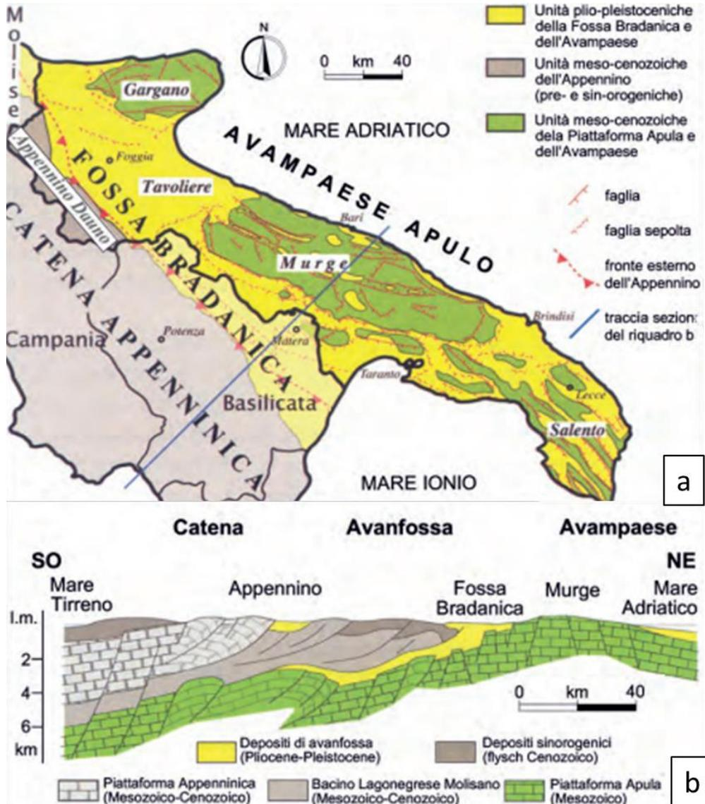
Figura 80. a) Carta geologica schematica (mod., da PIERI et alii, 1997); b) sezione geologica dell'Italia meridionale (mod., da SELLA et alii, 1988)
