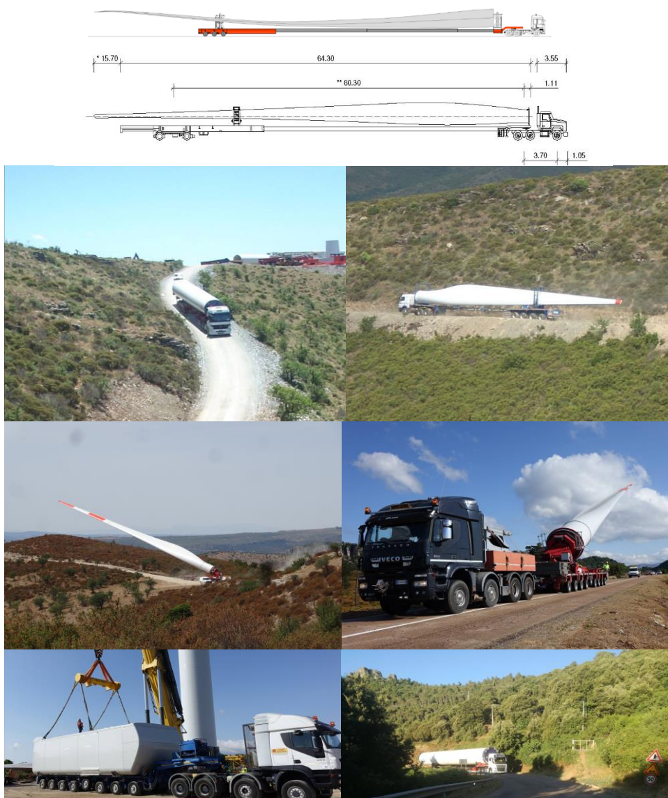
FIG. 16 – FASI DI TRASPORTO E TIPOLOGIA DEI MEZZI UTILIZZATI PER I TRASPORTI
