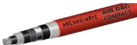
Il cavo sarà del tipo ARE4H5(AR)E o ARE4H5(AR)EX 18/30 kV le cui caratteristiche sono conformi alla norma HD 620/IEC 60502-2 con la seguente composizione: anima costituita da conduttore a corda rotonda compatta di alluminio, semiconduttore interno in mescola estrusa, isolante in mescola di
