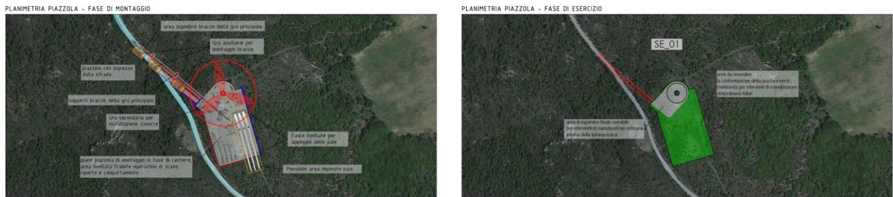
Figura 15: schematizzazione della piazzola dell'Aerogeneratore IS_02 in fase di cantiere e in fase di esercizio.
