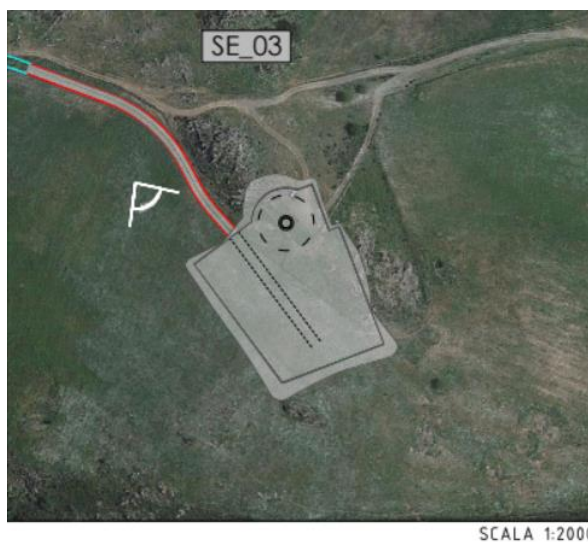
Figura 19. Posizione della piazzola su foto da satellite e vista del punto di Lay-out del previsto aerogeneratore SE_03 (Scala 1:2000; dalle Tavole tecniche: SE_PC_T008.1 - Analisi Piazzole).
