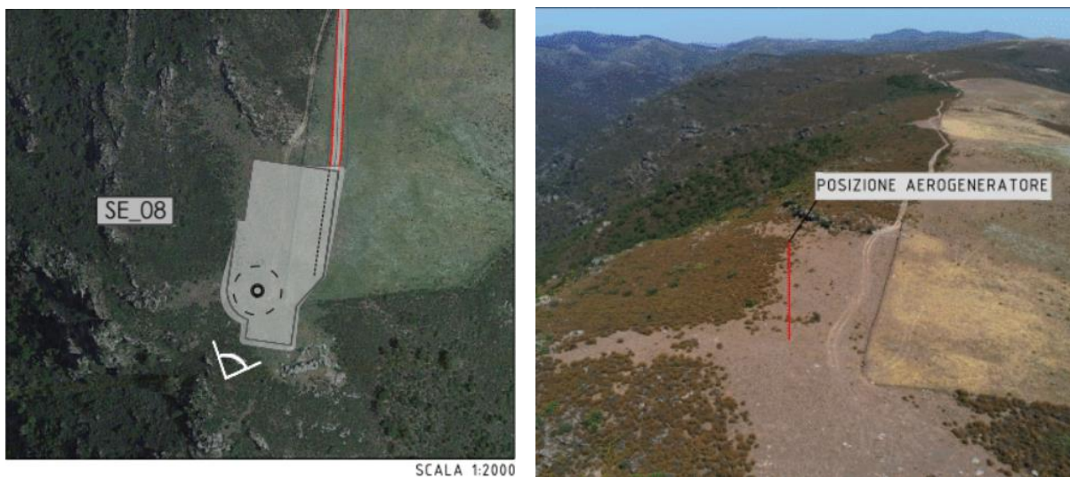
Figura 24. Posizione della piazzola su foto da satellite e vista del punto di Lay-out del previsto aerogeneratore SE_08 (Scala 1:2000; dalle Tavole tecniche: SE_PC_T008.2 - Analisi Piazzole).
