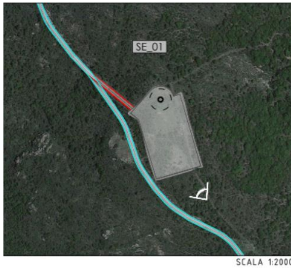
Figura 17. Posizione della piazzola su foto da satellite e vista del punto di Lay-out del previsto aerogeneratore SE_01 (Scala 1:2000; dalle Tavole tecniche: SE_PC_T008.1 - Analisi Piazzole).
