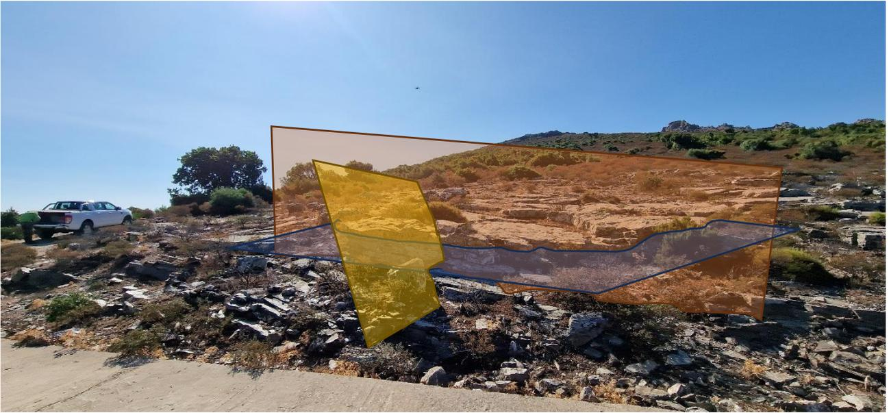
Figura 18 Esempio di disposizione a franapoggio nelle filladi, sono evidenti i piani che identificano le famiglie di giunti
