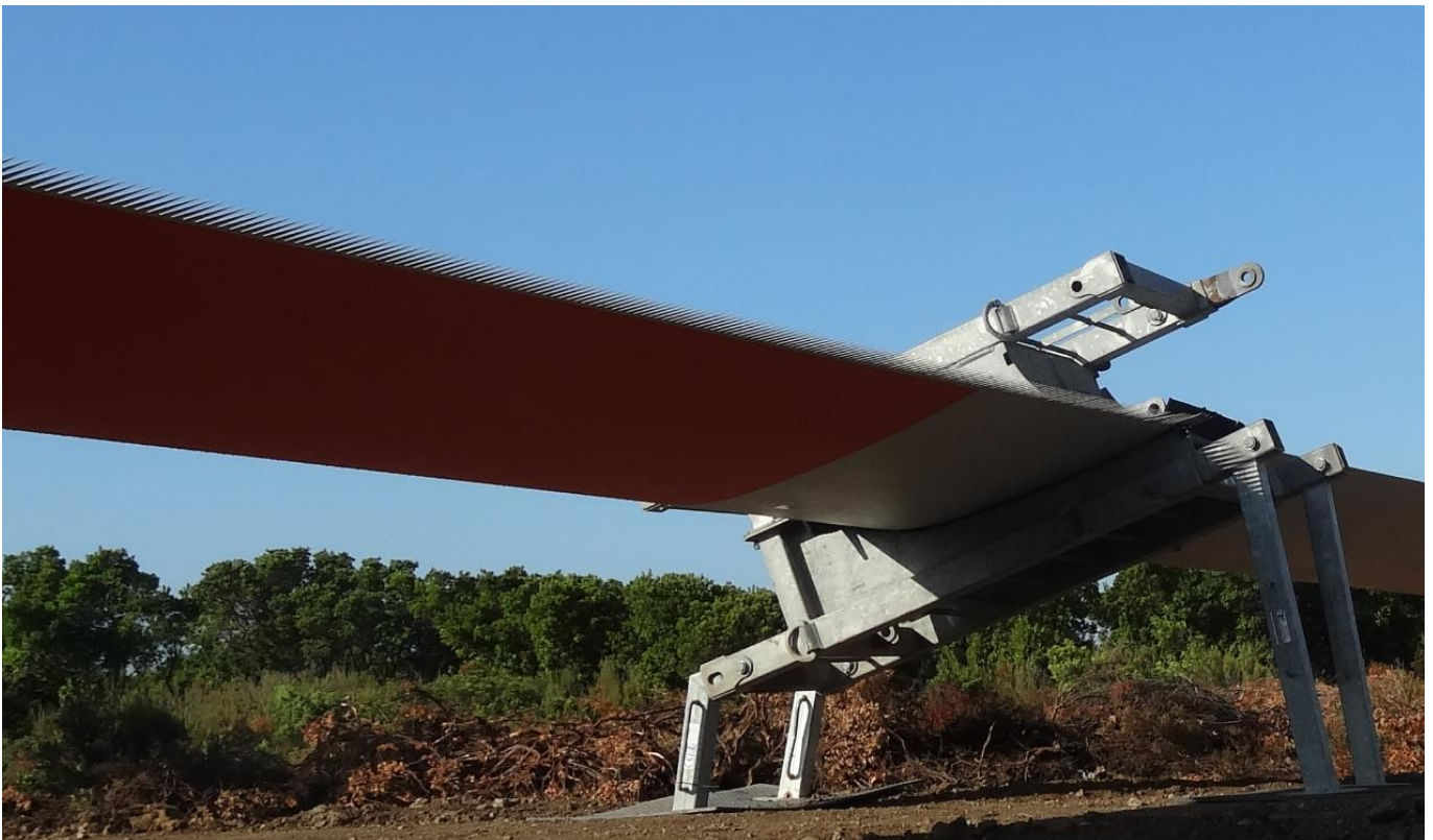
Figura 4 Pala di aerogeneratore con bande dentellate
