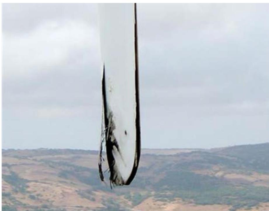
Secondariamente è necessario precisare che le WTG sono dotate di un sistema di sicurezza in grado di mandare in pausa la macchina a seguito di sbilanciamenti del rotore, eccessivo carico aerodinamico sulla pala o scostamenti sensibili tra velocità del vento e power curve.
