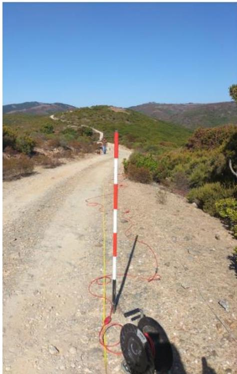
**Sismica con metodo di sismica a Rifrazione R3
