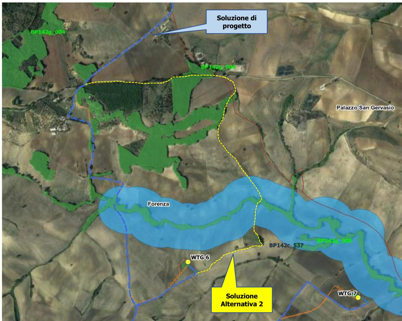
Figura 11-4: Analisi alternative del tracciato di cavidotto (Alternativa 2)
