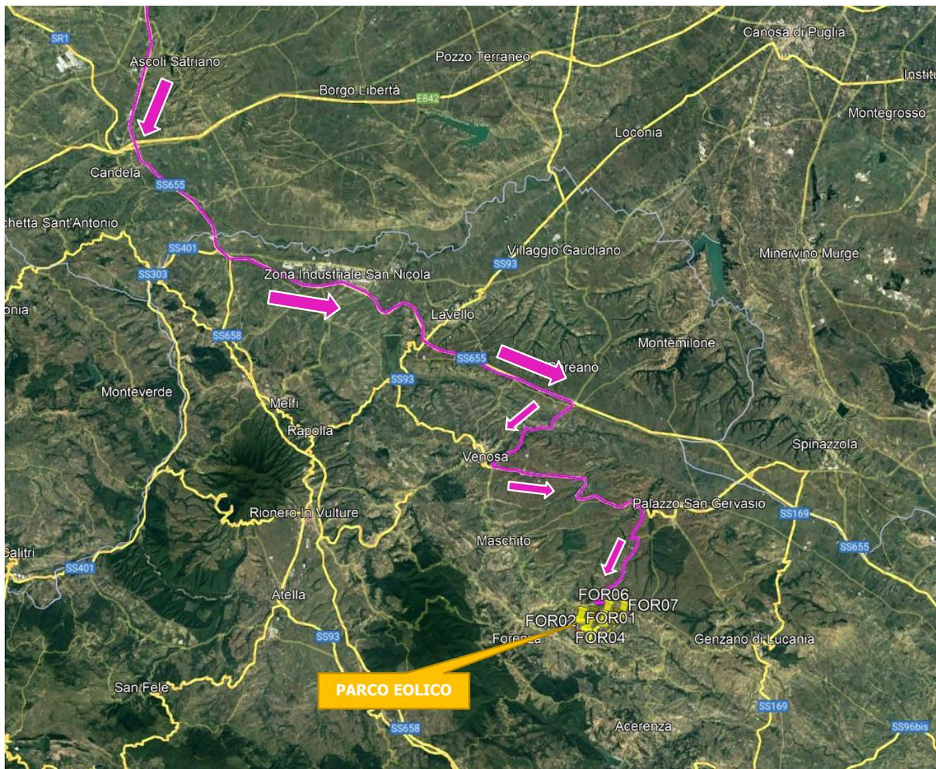
*Figura 2-2: Percorso trasporto componenti delle turbine*
