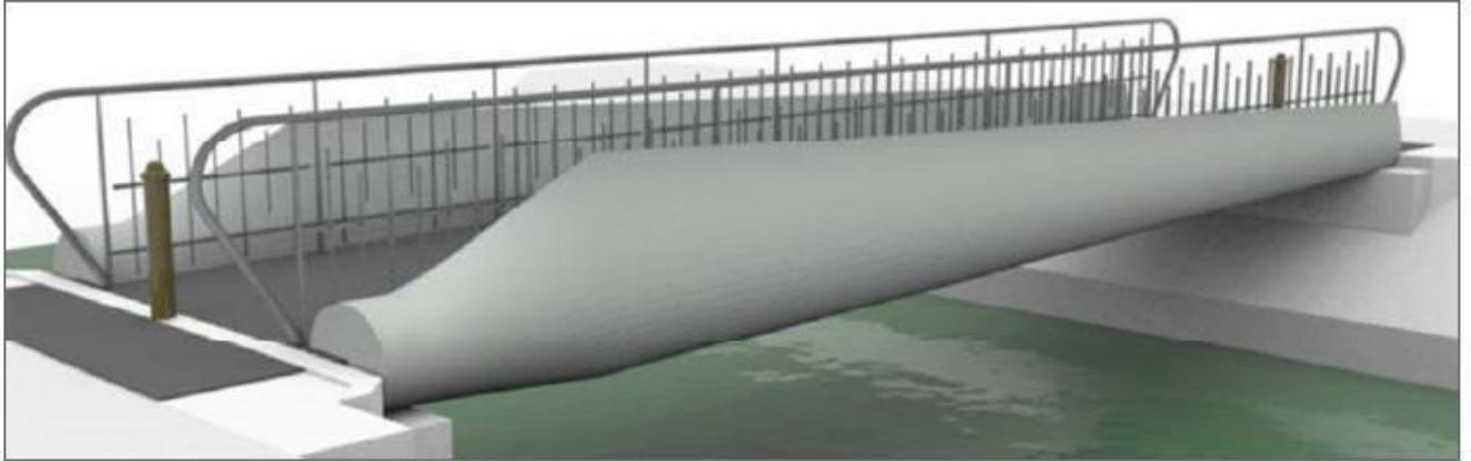
*Figura 3-12: Esempio di riutilizzo: Un progetto concettuale di ponte pedonale che utilizza pale eoliche come travi principali - progetto di ricerca Re-Wind*
