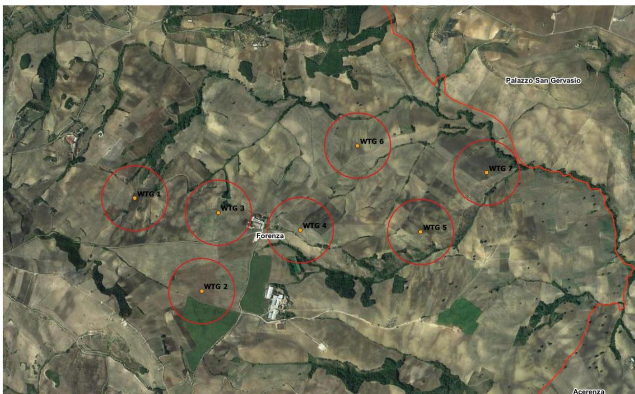
**Figura 1 – Indicazione della gittata massima della pala in caso di distacco**
