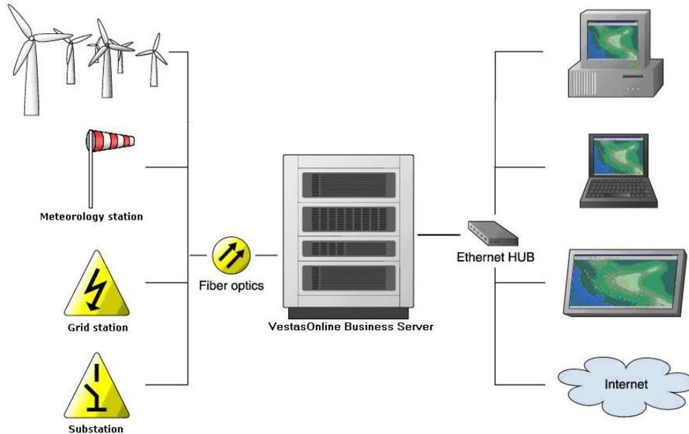
**Figura 2 Schema Sistema Scada**
