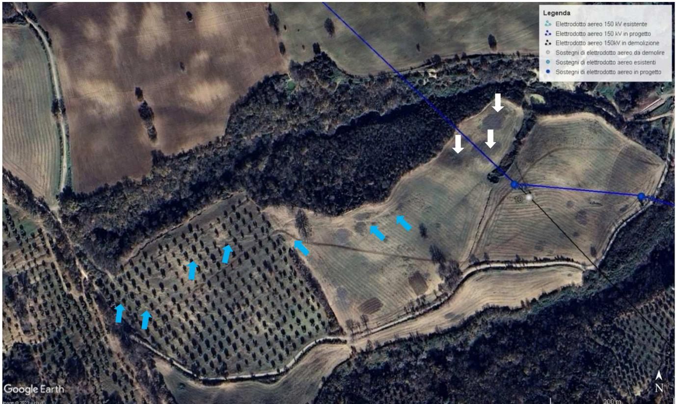
Foto 4-12. Ortofoto 2023 a colori – focus sul versante nell’area limitrofa a A17. Le frecce bianche indicano vegetazione infestante arbustiva, le frecce blu indicano segni di ruscellamento superficiale concentrato.
