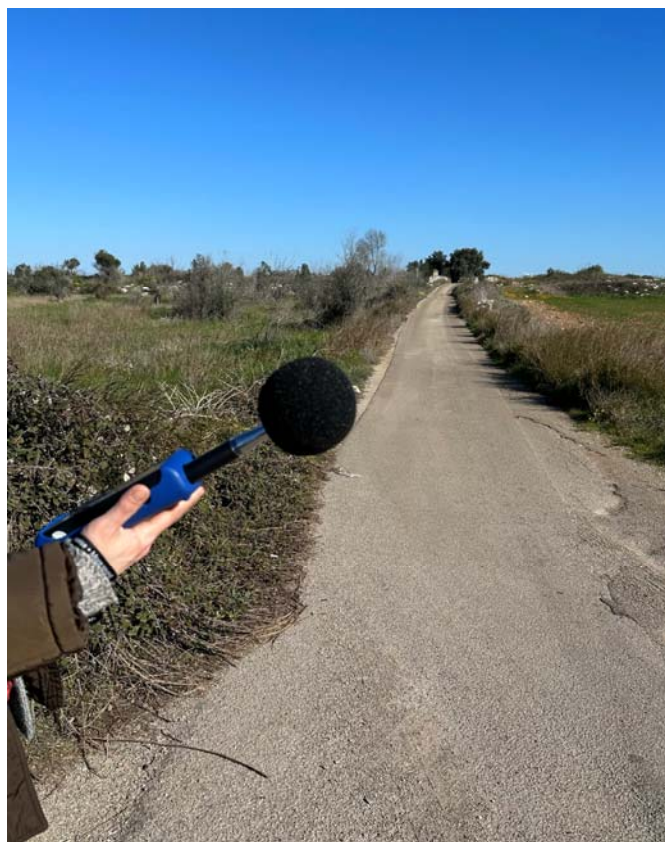
Foto 1 – Rilievo del rumore lungo il confine del campo FV 61_LECCE
