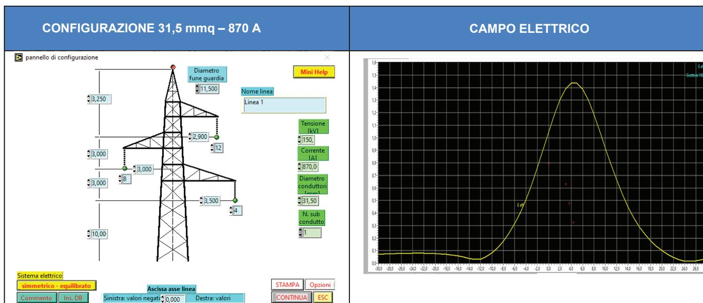
Come si evince dalle simulazioni effettuate il valore del campo elettrico, a 1.5 m dal suolo, è sempre inferiore al limite di esposizione di 5 kV/m previsto dal DPCM 08/07/03.
