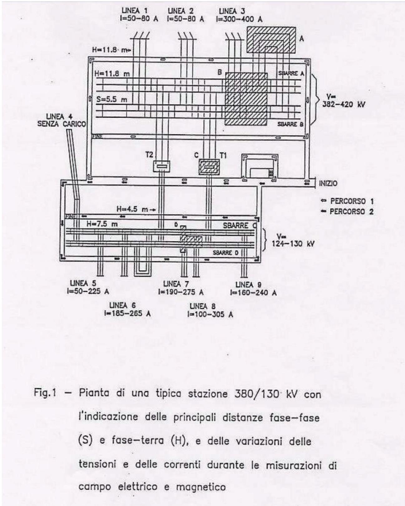
Fig.1 – Pianta di una tipica stazione 380/130 kV con l'indicazione delle principali distanze fase-fase (S) e fase-terra (H), e delle variazioni delle tensioni e delle correnti durante le misurazioni di campo elettrico e magnetico
