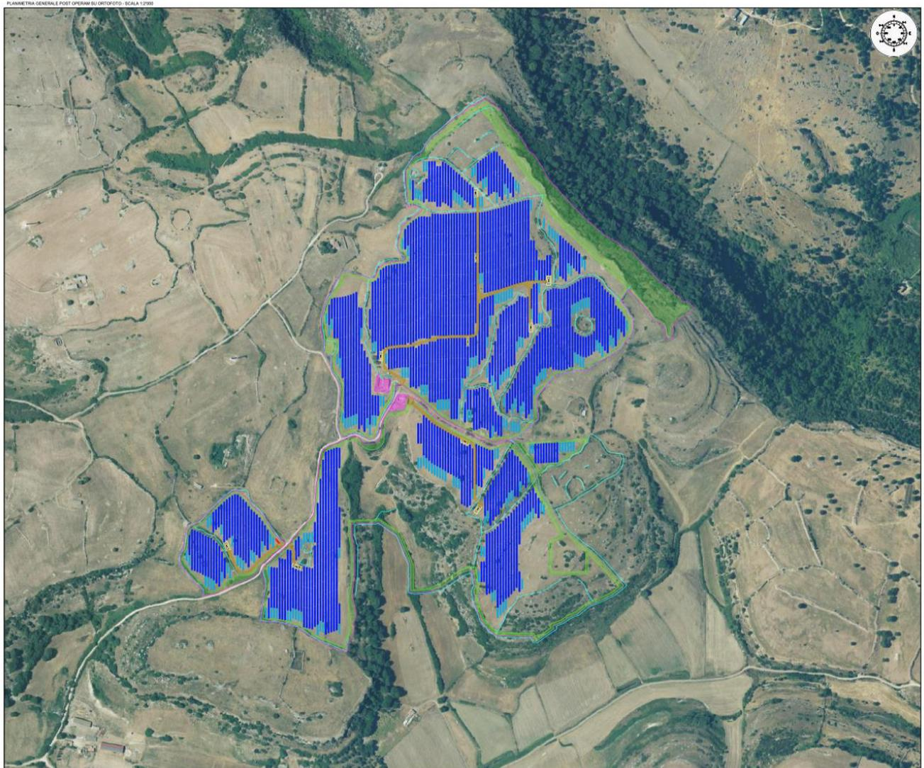
La realizzazione dell'impianto sarà eseguita mediante l'installazione di moduli fotovoltaici su strutture (Tracker) ad inseguimento monoassiale installate a terra tramite infissione di pali; i tracker hanno asse di rotazione disposto in direzione N-S e ruotano di +/- 60° in direzione E-O.
