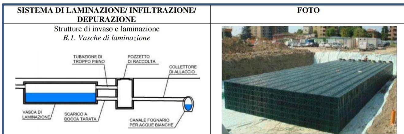
Le vasche di laminazione saranno realizzate in terra con sponde inclinate (rapporto H/L=2/3), con un franco di 50 cm e con un volume morto con altezza di 50 cm.
