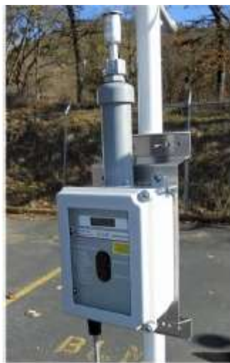
Strumentazione per la misura del particolato in continuo
