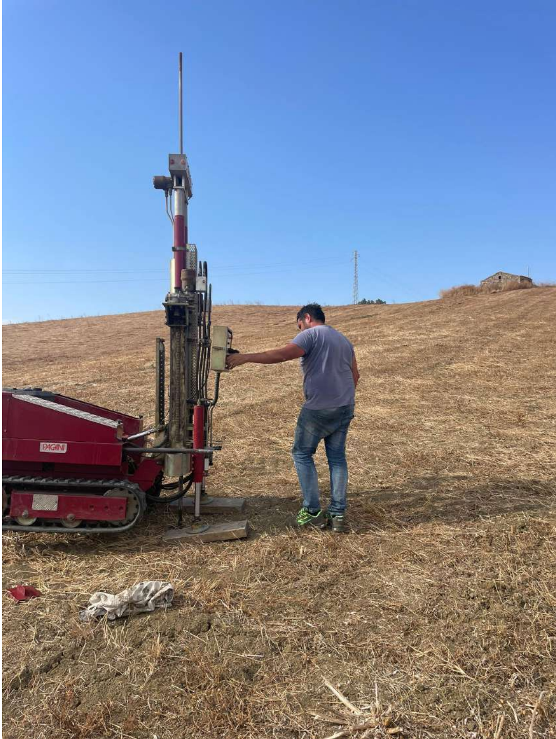
Prova DPSH 12 eseguita in situ
