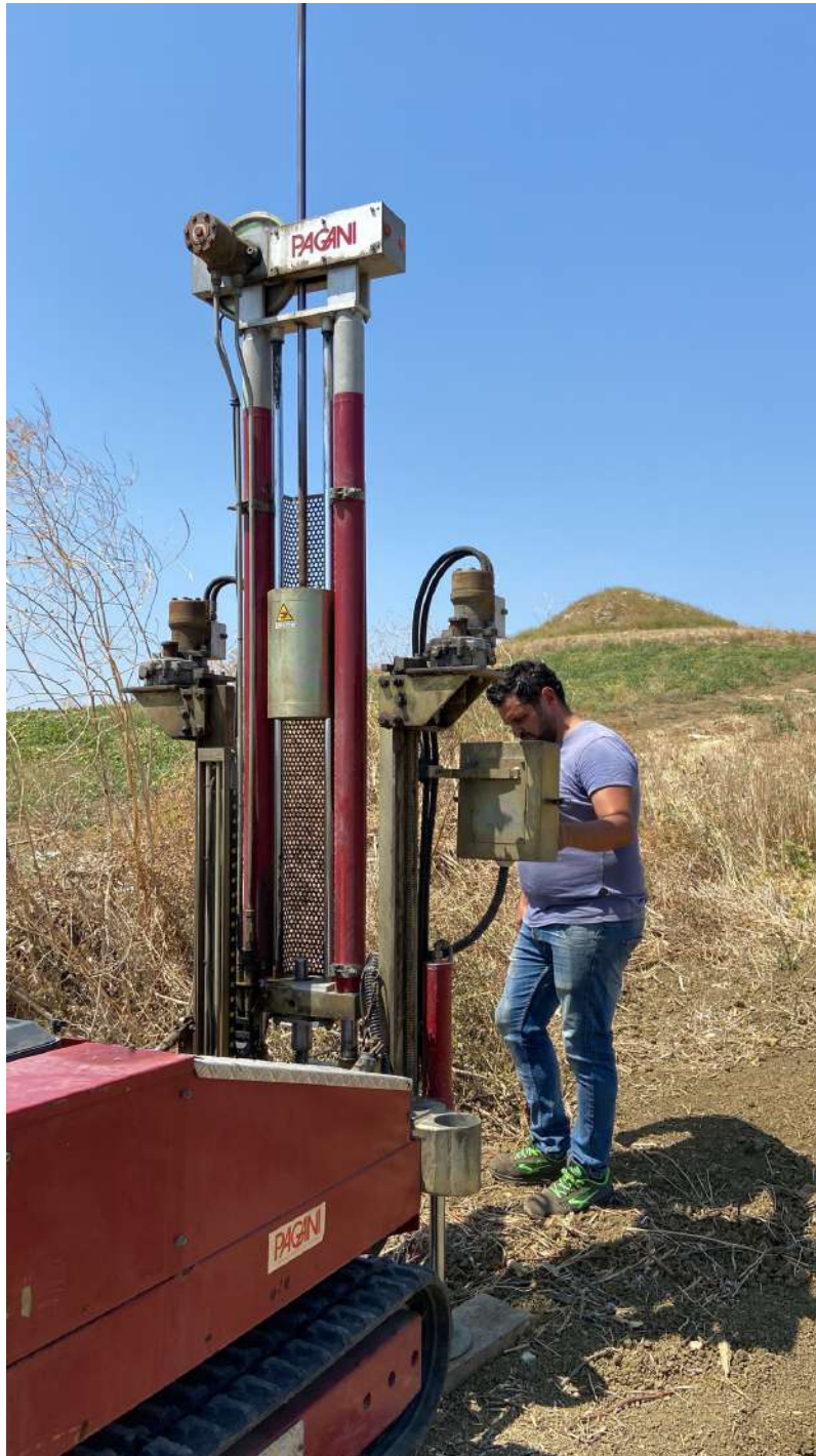
Prova DPSH 8 eseguita in situ
