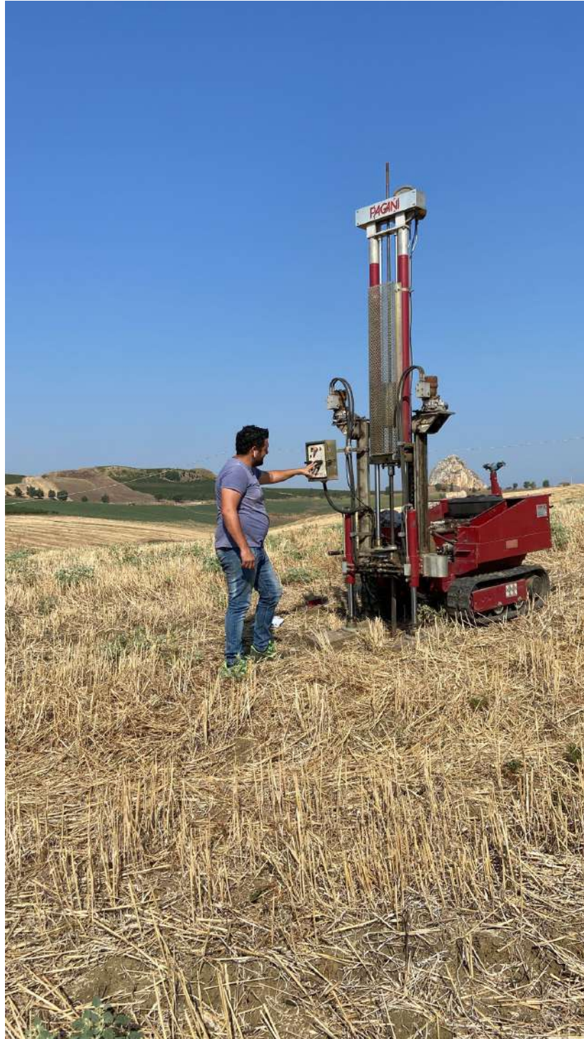
Prova DPSH 3 eseguita in situ
