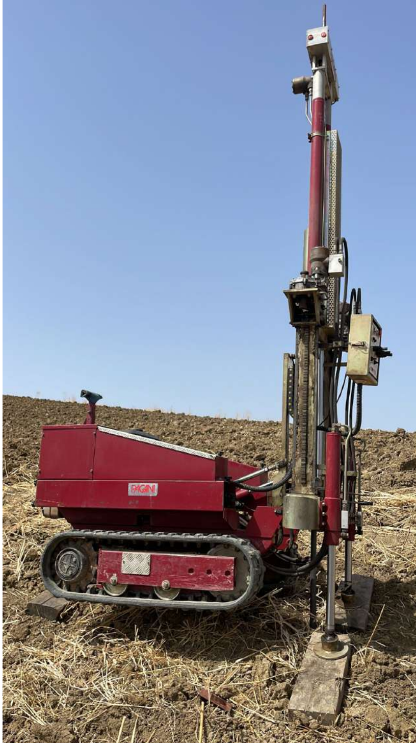
Prova DPSH 9 eseguita in situ
