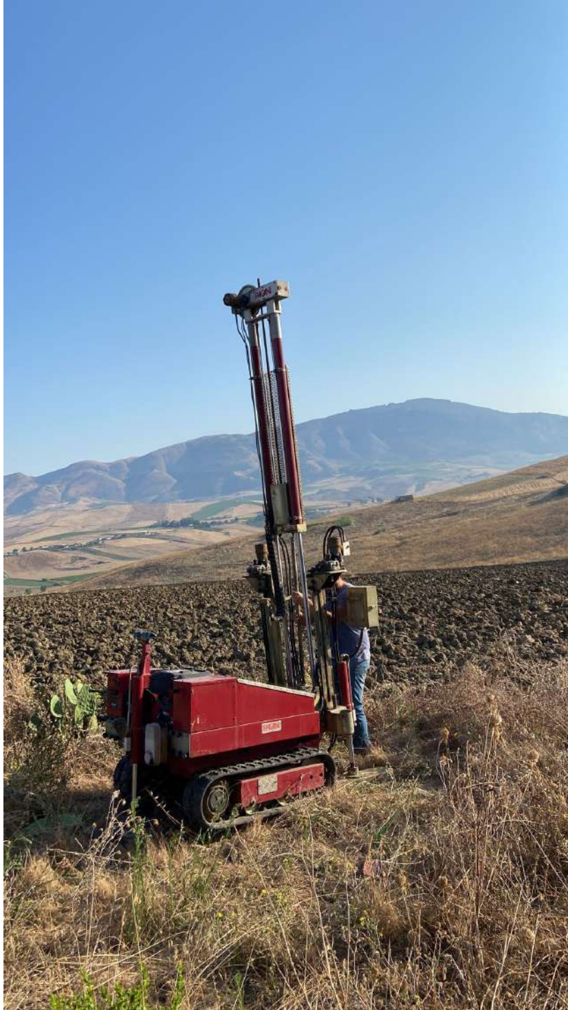
Prova DPSH 1 eseguita in situ
