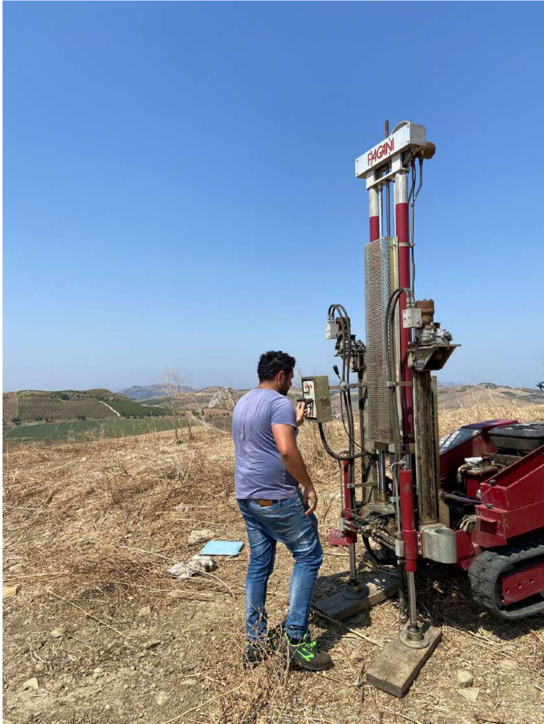
Prova DPSH 6 eseguita in situ
