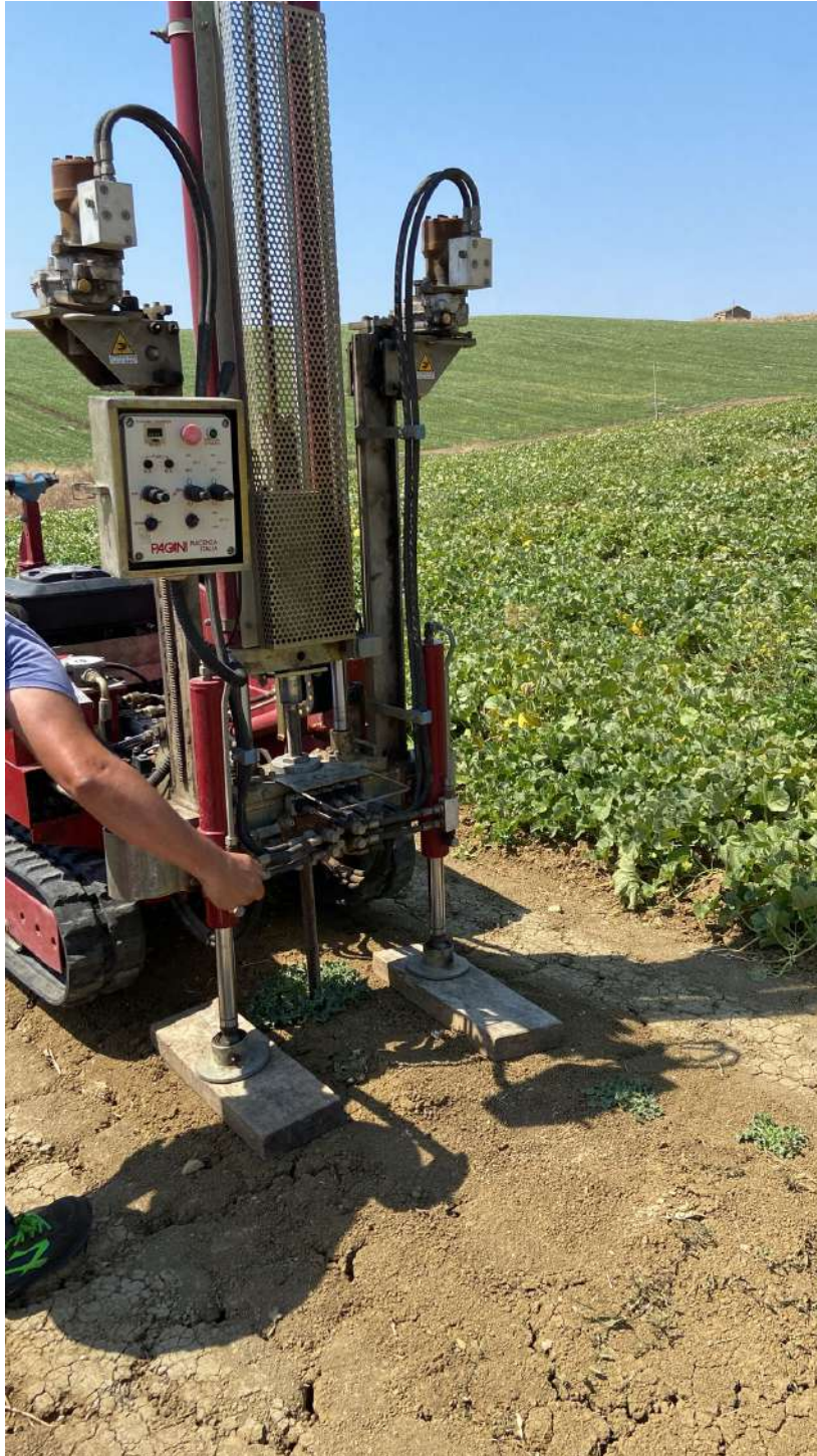
Prova DPSH 7 eseguita in situ
