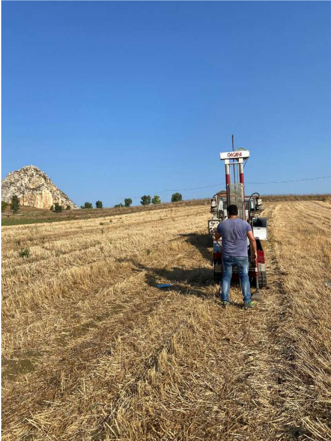
Prova DPSH 2 eseguita in situ
