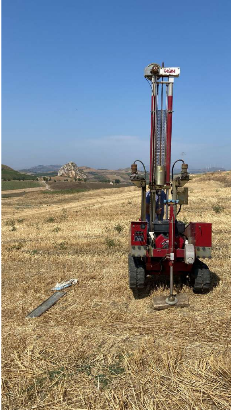
Prova DPSH 5 eseguita in situ
