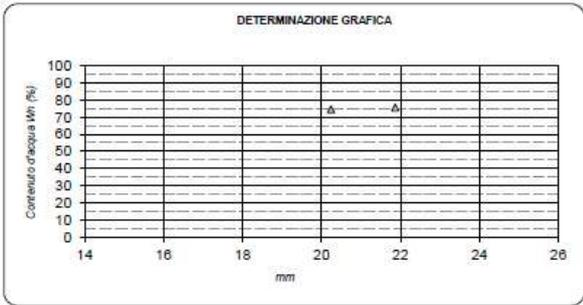
**Ottenuto che l'Indice di Plasticità (Ip) è pari al 34,10 %, ne consegue che secondo l'Eurocodice 8 (EC), essendo esso superiore a 10 è possibile omettere la verifica a liquefazione ai sensi del punto 7.11.3.4.2 delle N.T.C. 2018**
