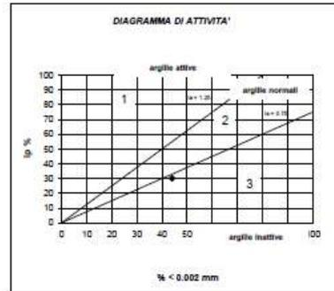
**Ottenuto che l'Indice di Plasticità (Ip) è pari al 30,12 %, ne consegue che secondo l'Eurocodice 8 (EC), essendo esso superiore a 10 è possibile omettere la verifica a liquefazione ai sensi del punto 7.11.3.4.2 delle N.T.C. 2018.**
