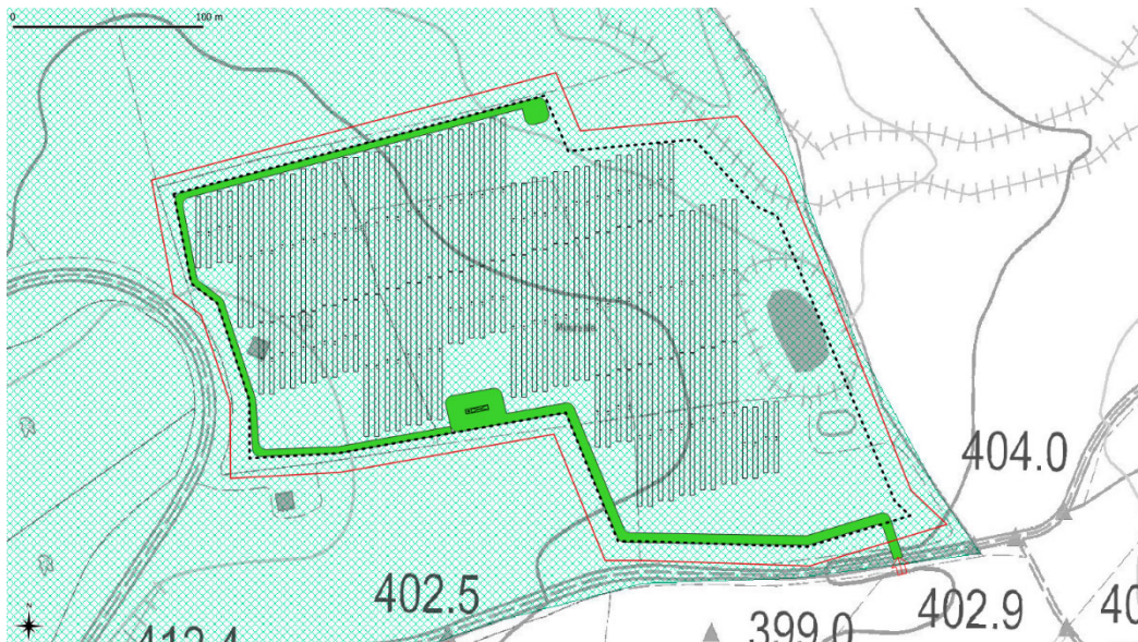
Particolare della viabilità (in verde) interna al sottocampo n.7 ricadente in area soggetta a vincolo idrogeologico
