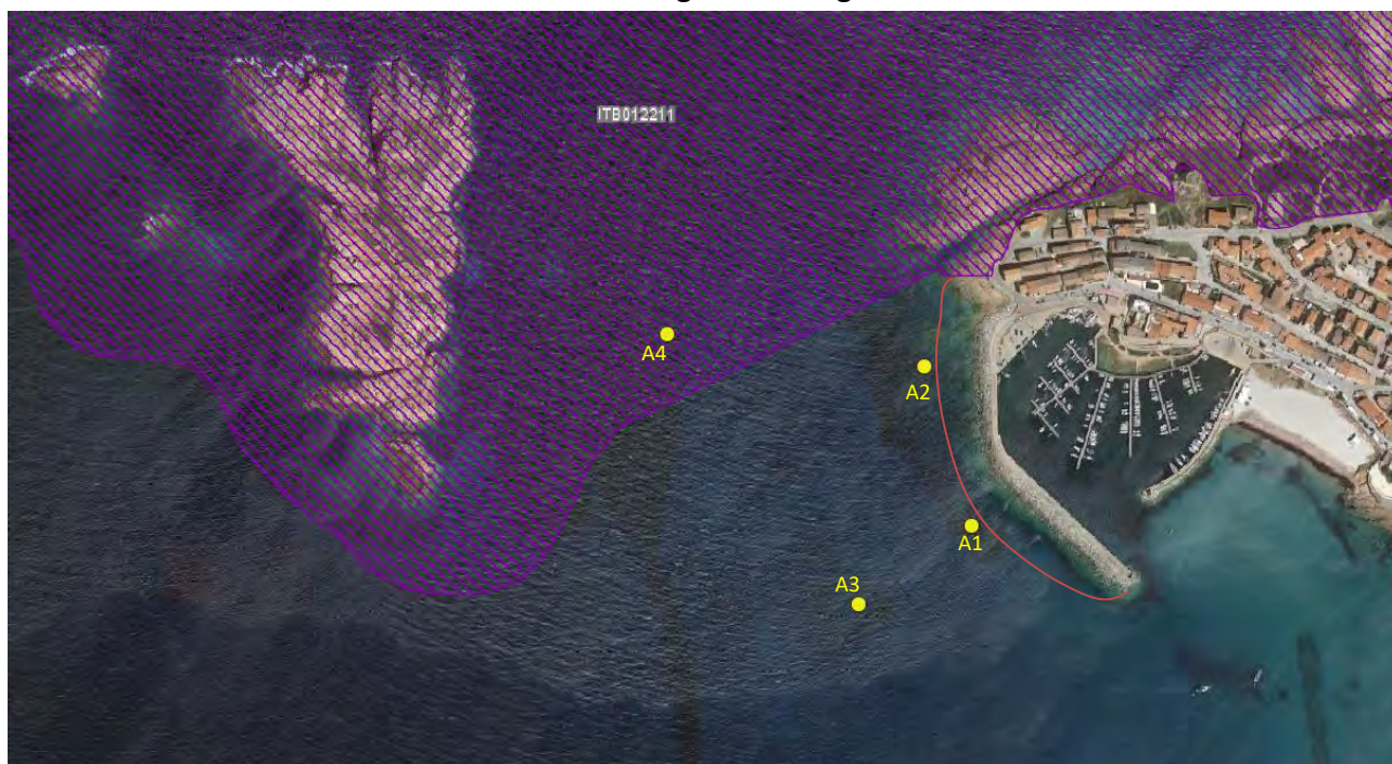
Figura 32: stazioni di misurazione indicative area di intervento; in rosso le panne galleggianti
