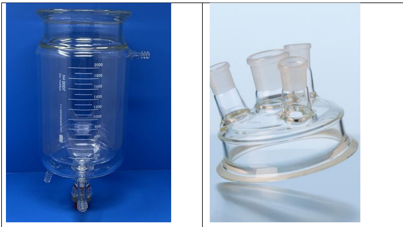
Figura 12. Reattore incamiciato in vetro Pyrex e relativo coperchio di chiusura
