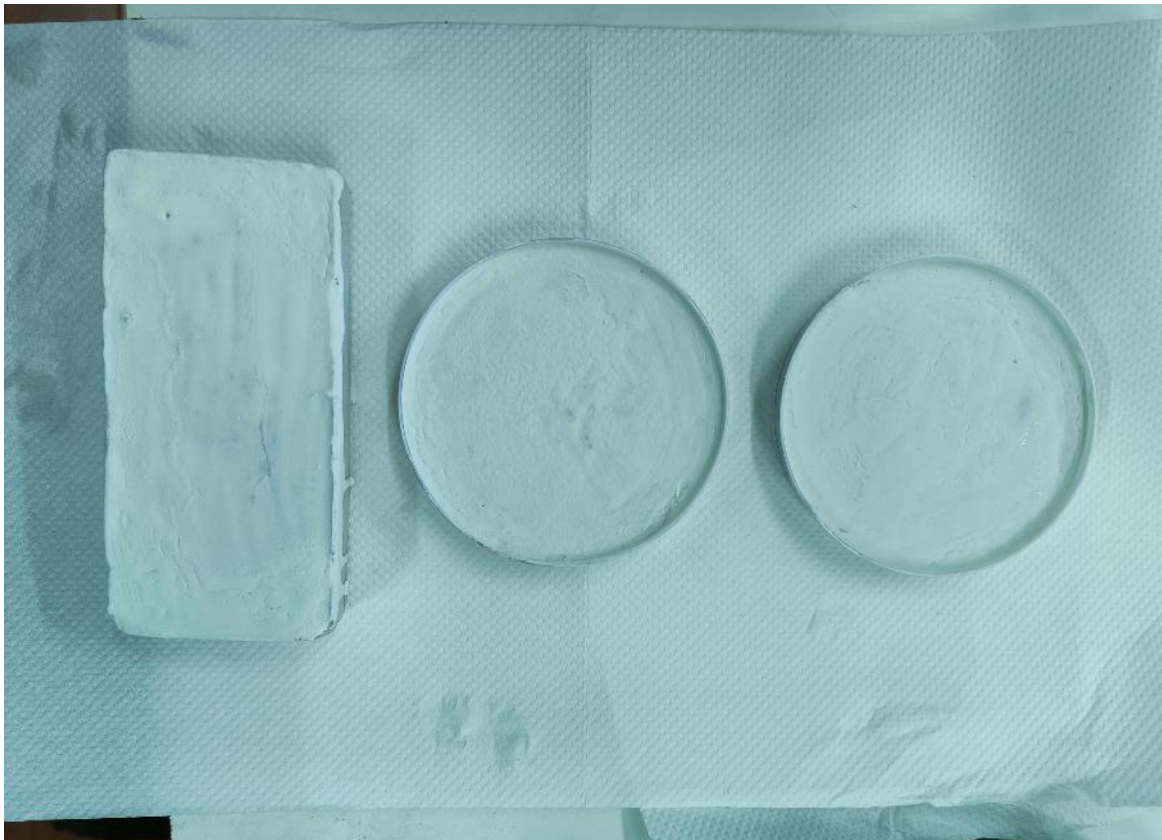
Figura 9. Provini dopo l'applicazione della vernice secondo le istruzioni di posa del costruttore
