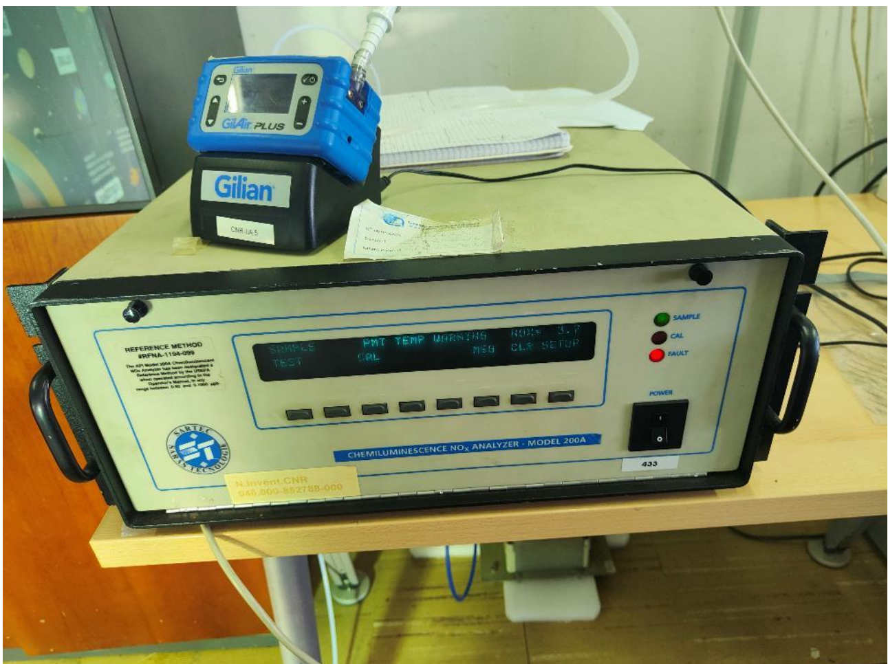
Figura 16. Analizzatore a chemiluminescenza e pompa supplementare per la regolazione del flusso di aspirazione
