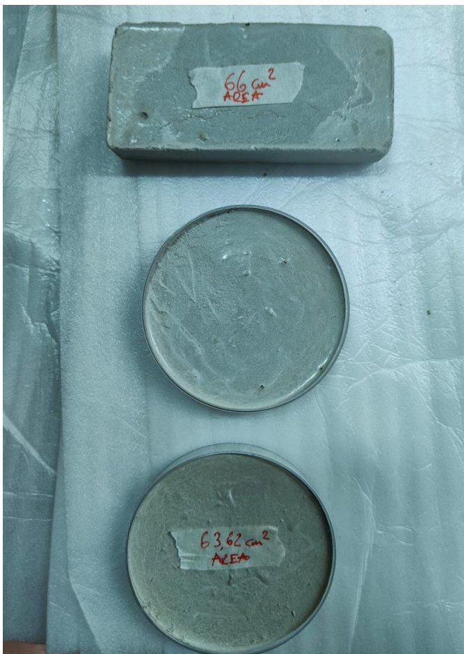
Figura 8. Provini utilizzati per la prova con indicazione dell'area della superficie
