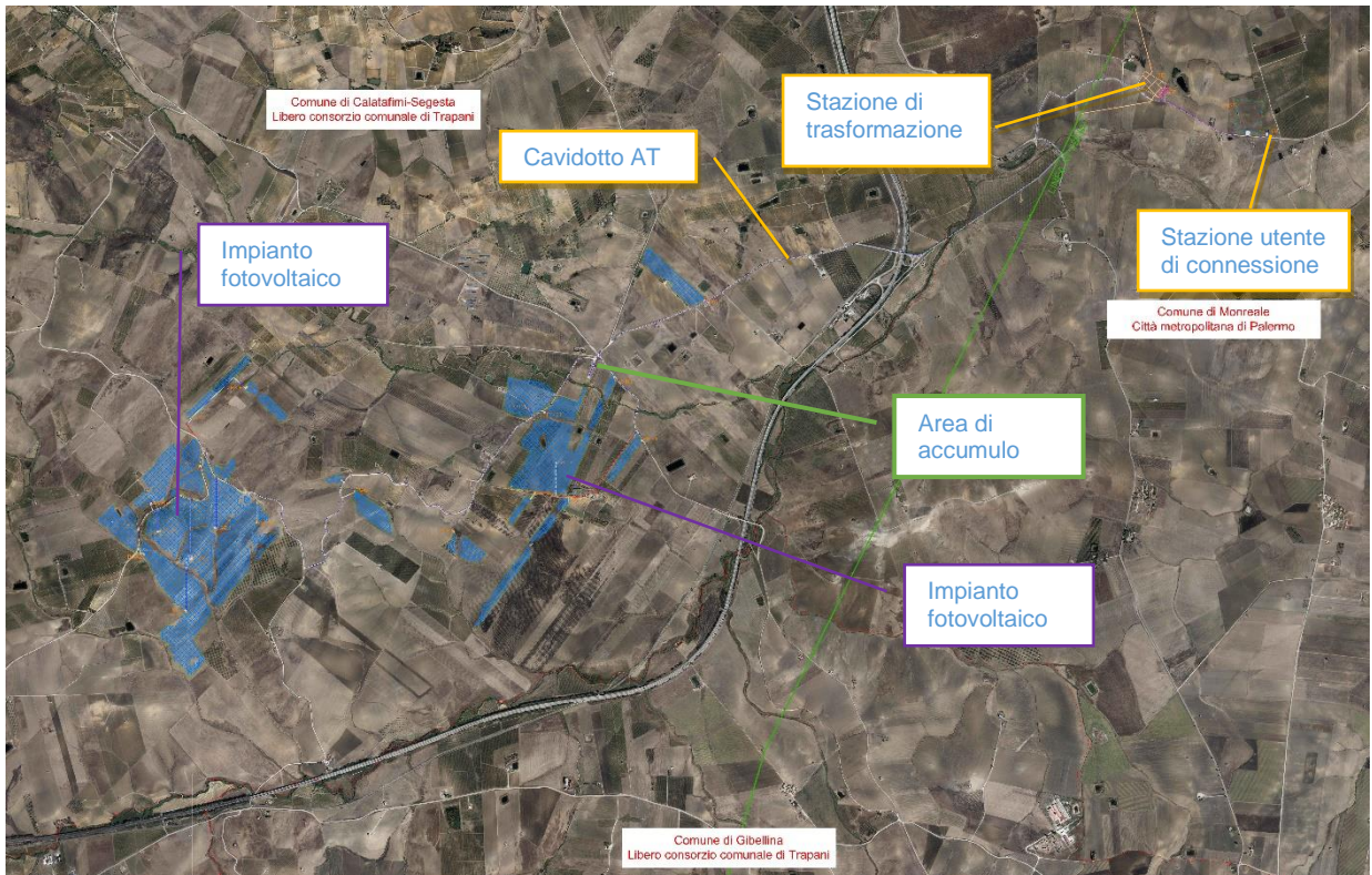
Figura 3.2 Inquadramento impianto in progetto
