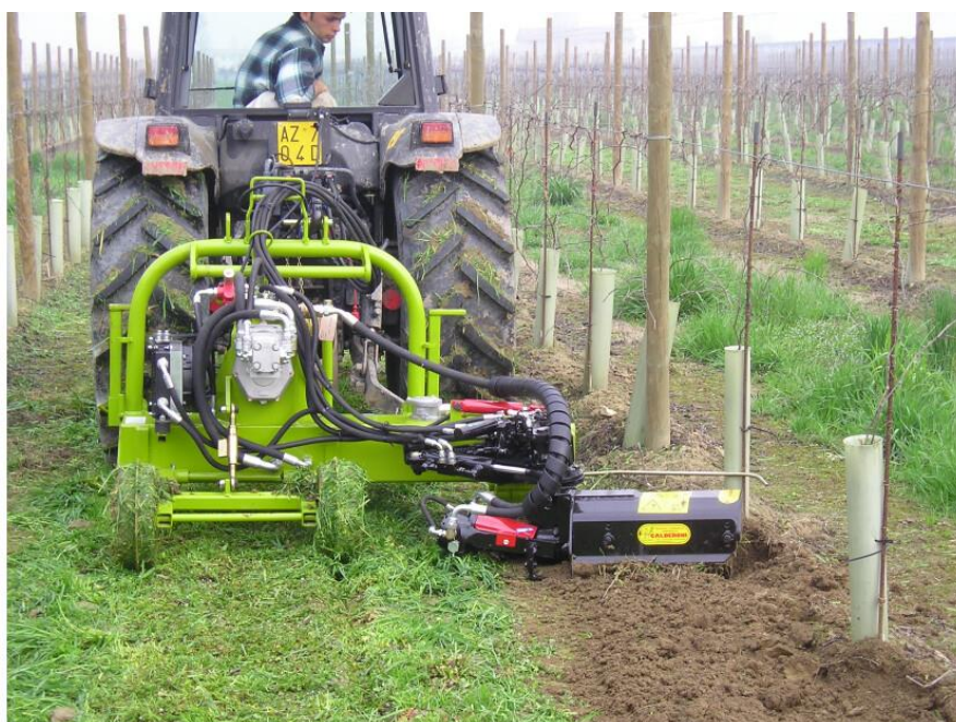
Esempi di fresatrici interceppo per le lavorazioni sulla fila (dal web)
