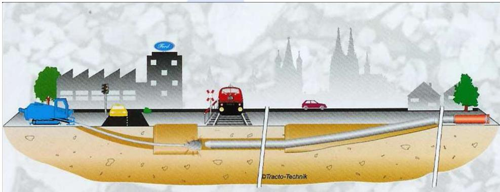
**Fig. 7** – Schema di principio dell'attraversamento in T.O.C.
